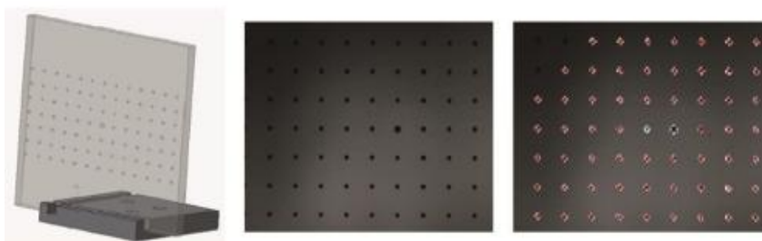
Слика 20 – 2D приказ калибрационих плоча са матрицом тачака [15]
