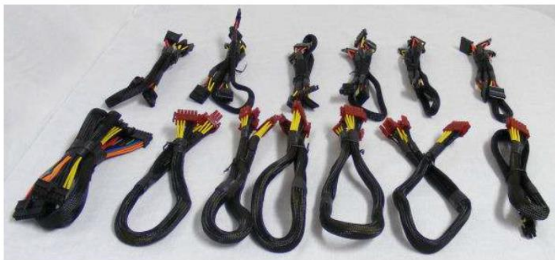
Слика 52 Променљиви каблови модуларног напајања
