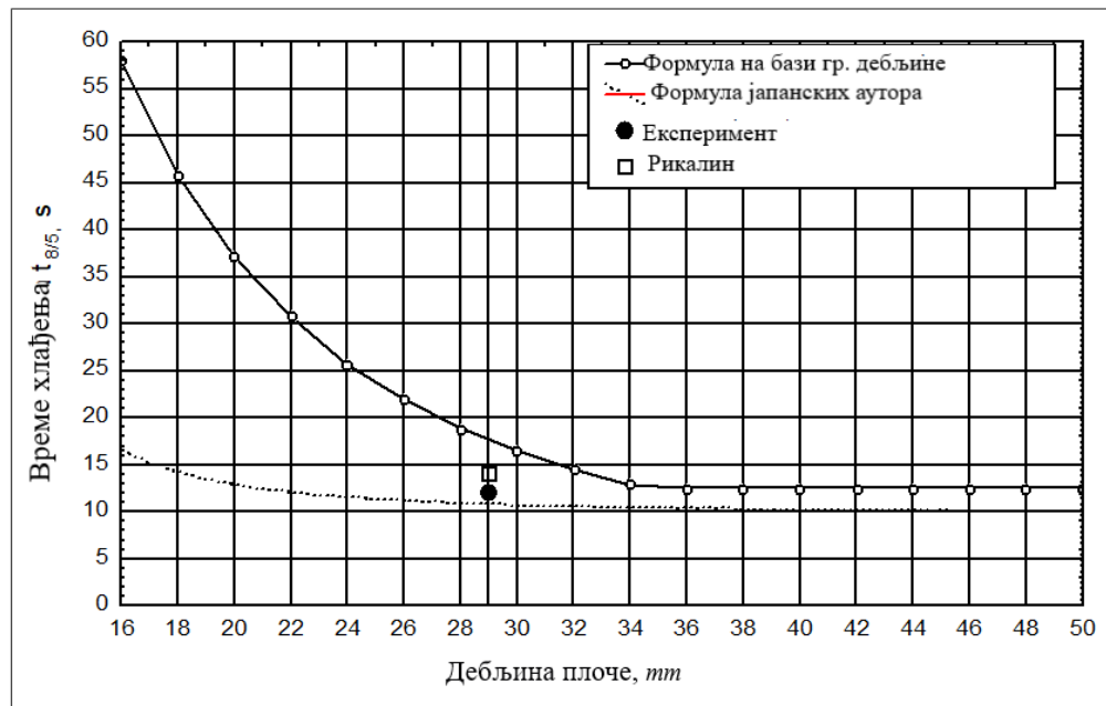
Слика 5.19 Упоредни резултати времена хлађења ( s = 29 \text{ mm} , d_e = 5 \text{ mm} , T_p = 204^\circ\text{C} , q_l = 16912 \text{ J/cm} )
