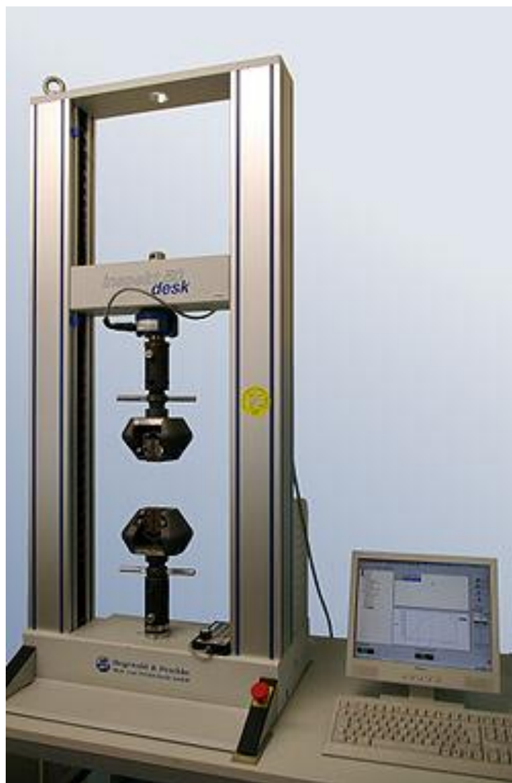
Слика 16. Универзална кидалица за оптерећења до 200 kN [8]
