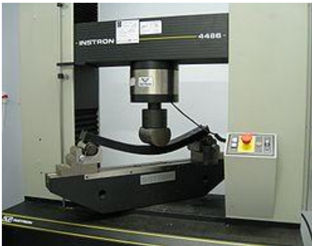
Слика 17. Испитивање у три тачке на кидалици [9]
