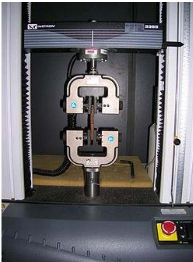
Слика 18. Испитивање на затезање на кидалици [9]
