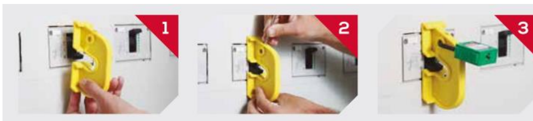
Слика 41. Поступак постављања блокатора прекидача [21]
