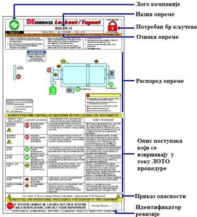
Слика 43. DEenergize™ ЛОТО процедура са идентификацијом основних елемената [27]
