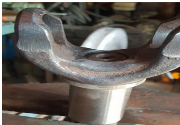
Слика 57. Монтирање канџе
