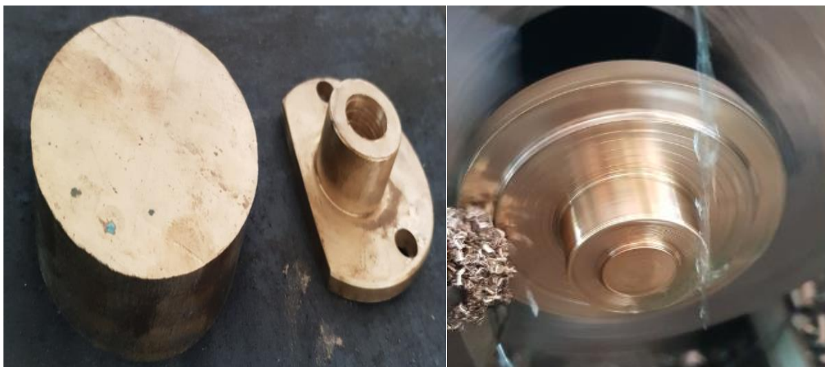
Слика 38. Избор одговарајућег материјала за израду навртке и почетак стругарске обраде
