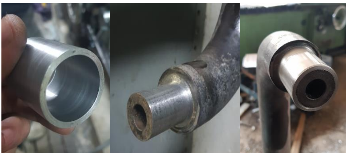
Слика 50. Монтажа чауре
