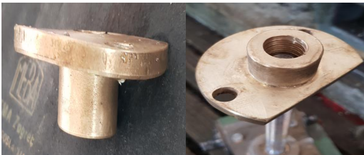
Слика 22. Специјална навртка за померање фирунга на блањалици за дрво
