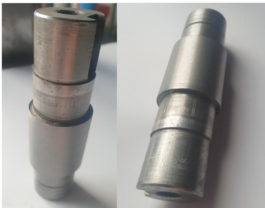
Слика 60. Оштећена осовина редуктора
