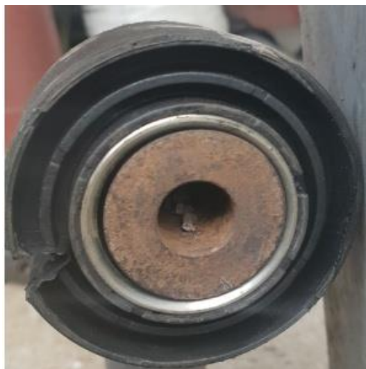
Слика 47. Зазор између баланс штангле и силен блока
