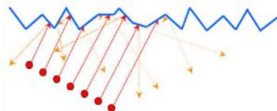
Слика 12 – Појава распршења звучног таласа [2]
