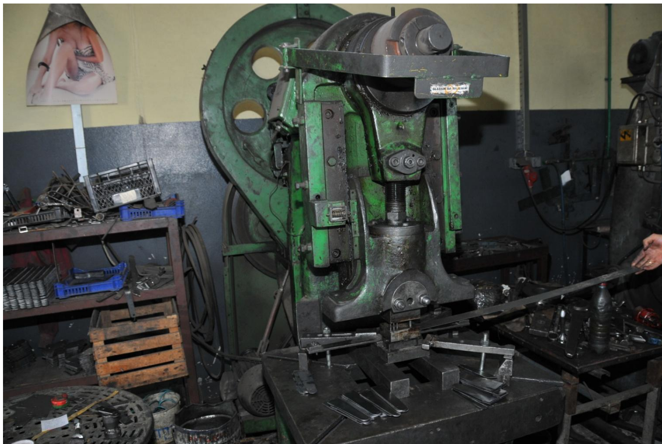
Слика 2. 2. Ексцентар преса на којој се врши просецање у предузећу „ МБМ Пожега ”
