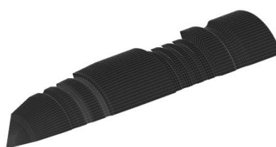
Слика 3.10. МКЕ модел панцирног језгра
