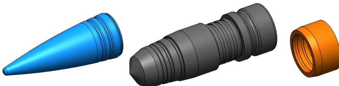
Слика 3.2. Изометријски приказ подсклопова панцирног пројектила калибра 30mm
