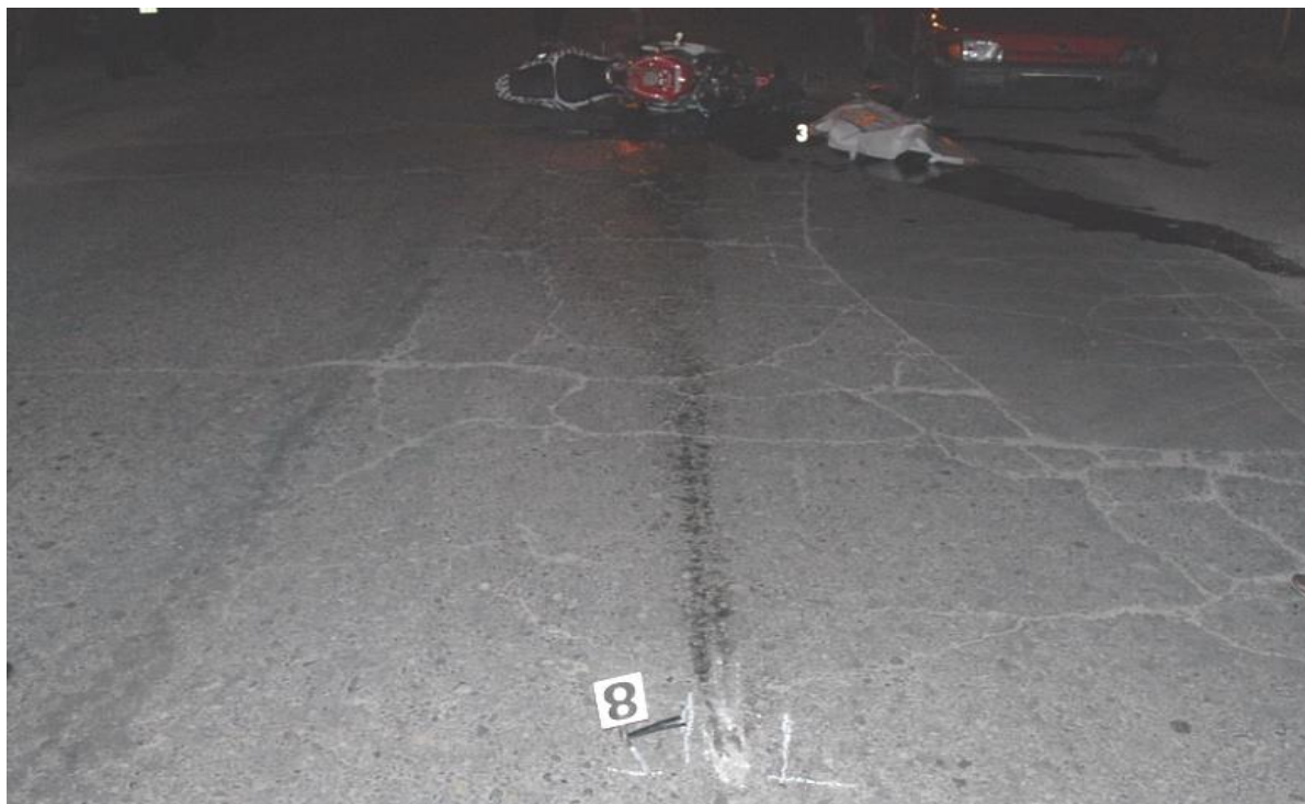
Слика 32. Траг гребања мотоцикла прекривен траговима уља [6]
