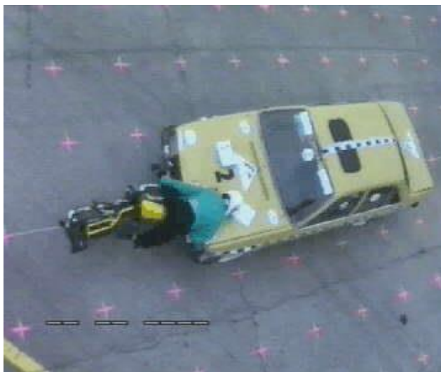
Слика 6. Чеони судар мотоцикла који се креће брзином од 40 [km/h] при чему тело мотоциклисте након 0,13 секунди пада на поклопац мотора путничког аутомобила [2, 4]
