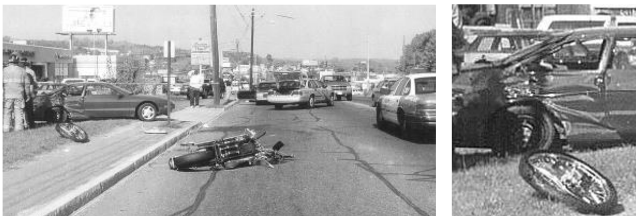
Слика 17. Зауставне позиције возила и оштећења на аутомобилу [6]
