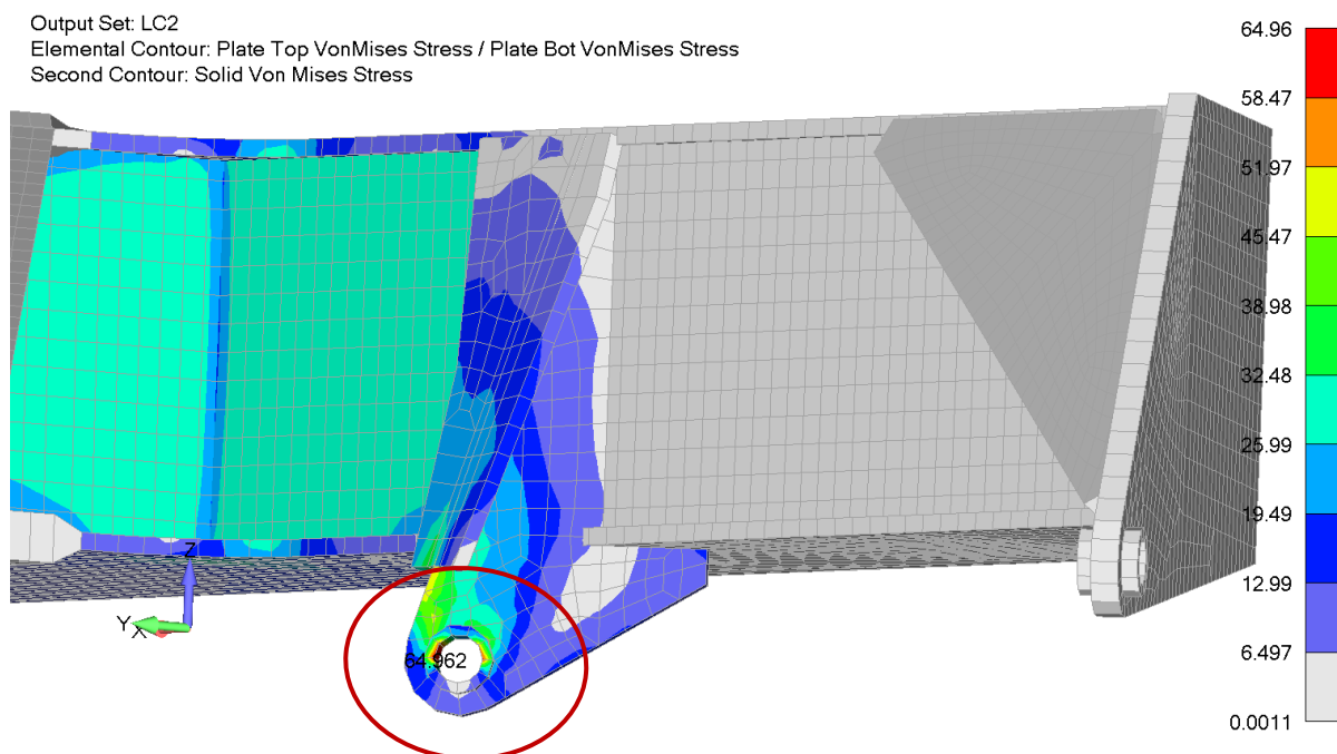
Слика 6.62 Место максималног ефективног напона – значајније оптерећена зона
