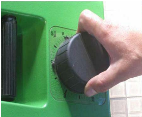
Слике 24 и 25 - Подешавање реглоскопа и положај реглоскопа у односу на возило
