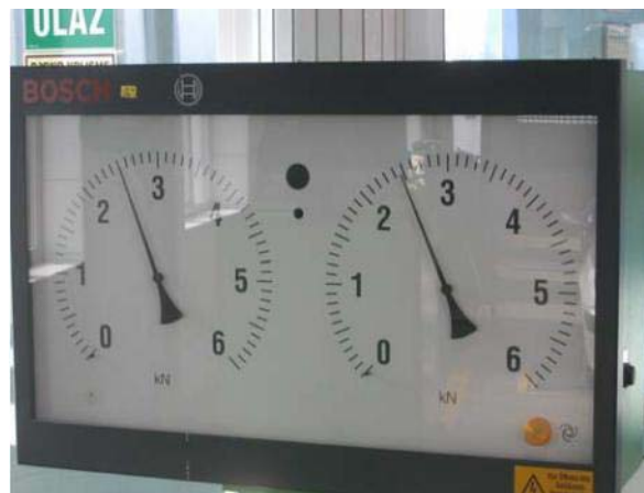
Слике 22 и 23 - Испитивање кочионих сила помоћу ваљака и графички приказ силе кочења
