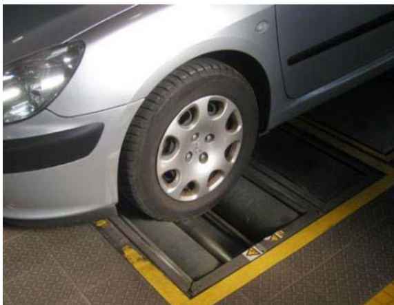
Слике 22 и 23 - Испитивање кочионих сила помоћу ваљака и графички приказ силе кочења
