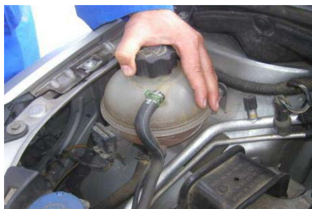
Слика 9 - Провера инсталације и целокупног система за хлађење мотора
