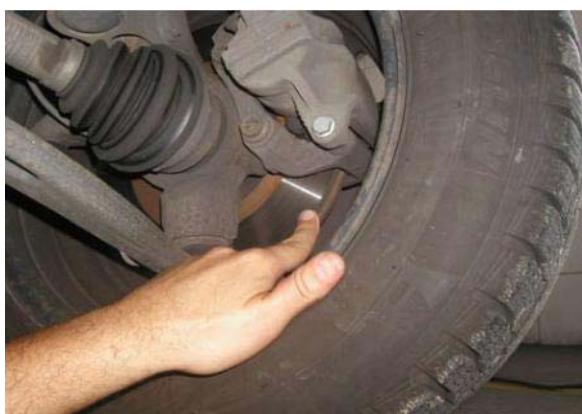
Слике 17 И 18 - Контрола дискова и контрола дозвољеног зазора у зглобовима
