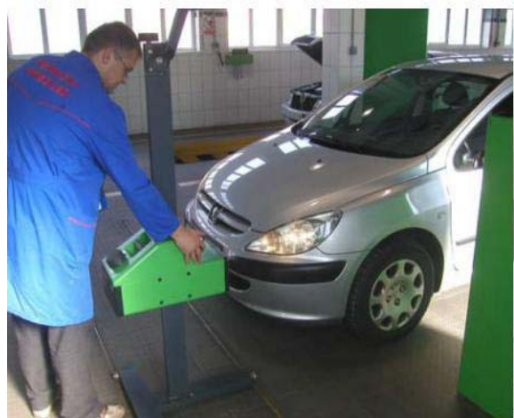
Слике 24 и 25 - Подешавање реглоскопа и положај реглоскопа у односу на возило
