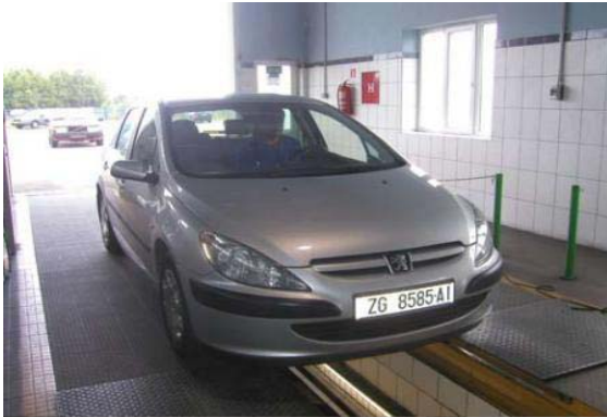
Слике 12 и 13 - Возило на каналу и провера причвршћености и буке издувног систем
