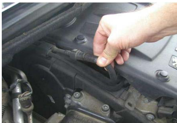
Слика 7 - Провера видљиве инсталације за довод горива
