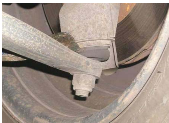
Слике 17 И 18 - Контрола дискова и контрола дозвољеног зазора у зглобовима
