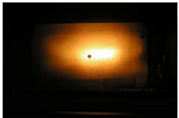
Слике 26 и 27 Приказ кратког светла у заслону реглоскопа и приказ дугог светла на заслону реглоскопа
