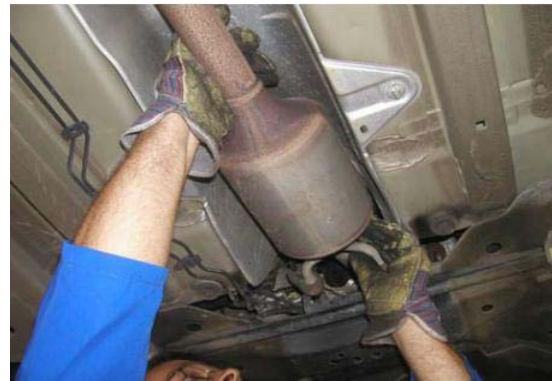
Слике 12 и 13 - Возило на каналу и провера причвршћености и буке издувног систем
