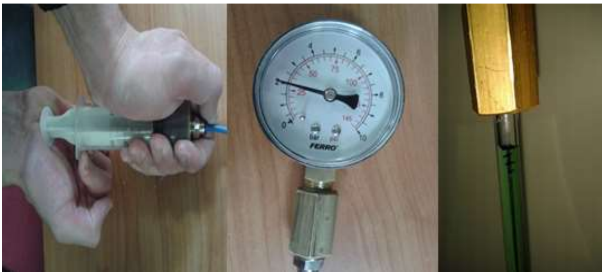
Слика 20. Задавање притиска (лево), читавање на манометру (средино) и означавање пад течности (десно)
