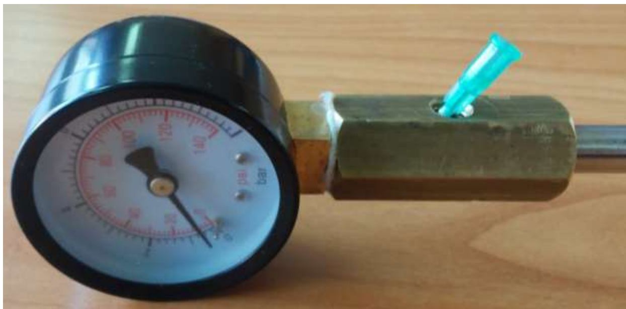
Слика 9. Спречавање стварања ваздушног мехура испред манометра
