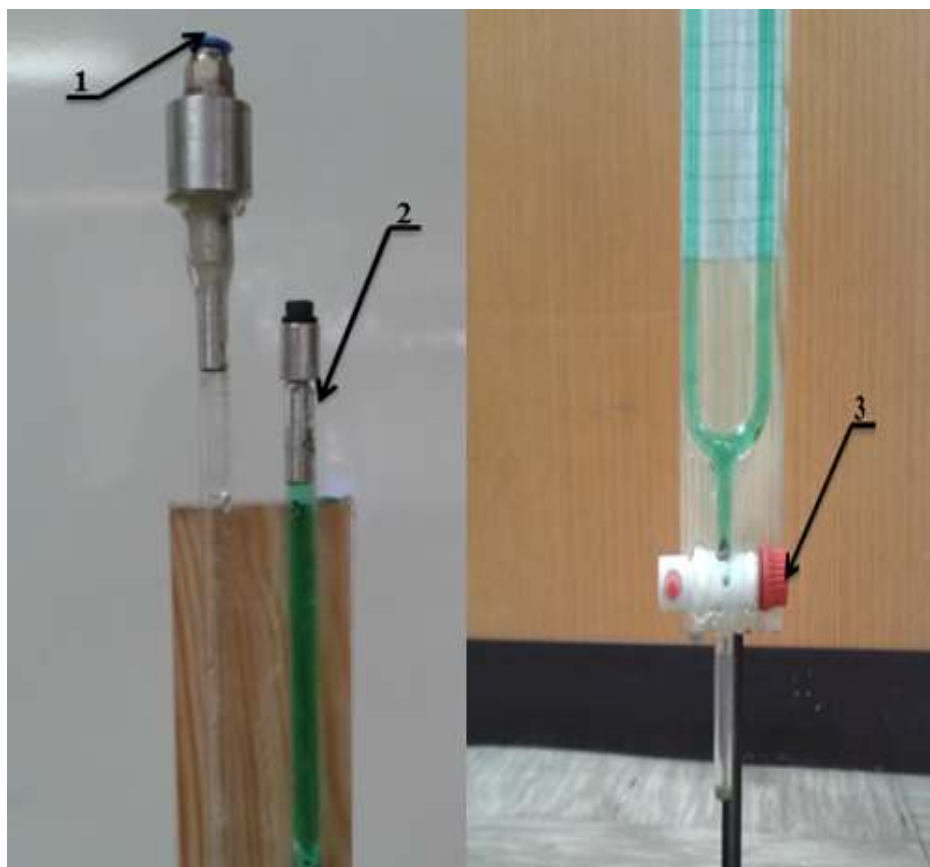
Слика 25. Провера да ли уређај испушта воду: 1 - задаје се максимални притисак, 2, 3 – место где се очекује да вода излази (цури)
