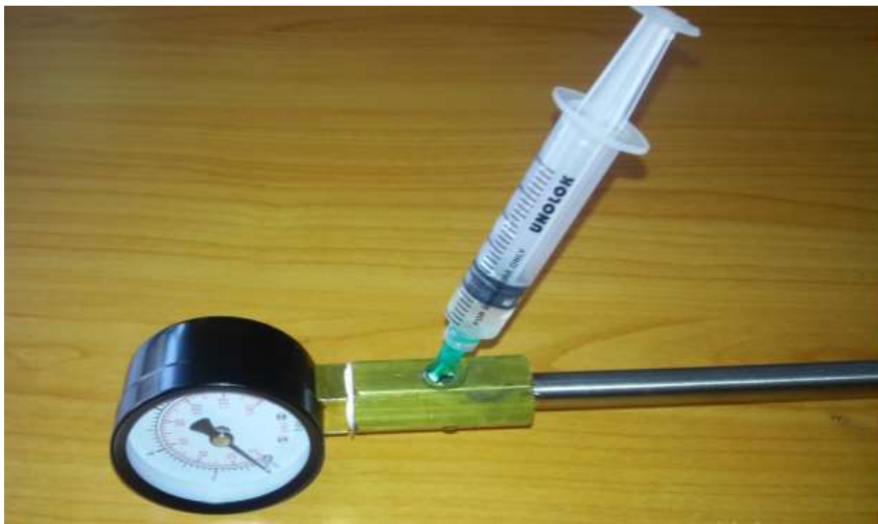
Слика 11. Отклањање ваздушних мехура из система
