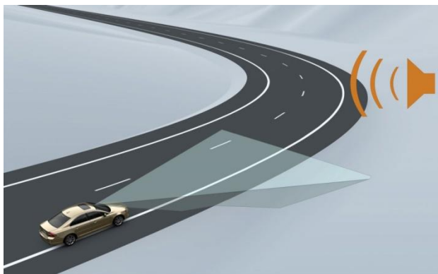
Слика 23. Систем упозоравања приликом преласка у другу траку (LDW)
