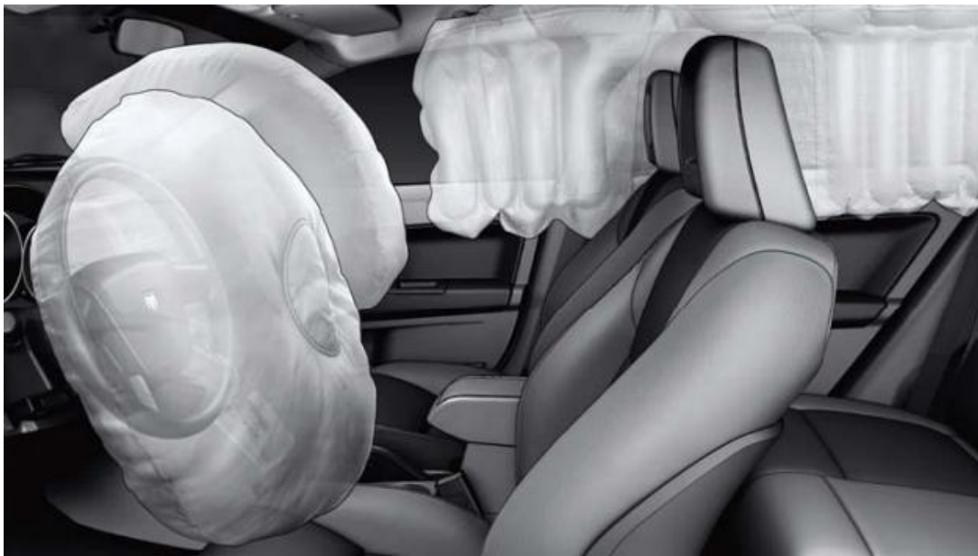
Слика 9. Ваздушни јастук за заштиту приликом бочних удара
