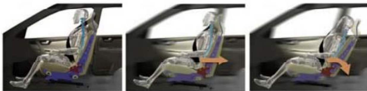
Слика 18. Функционисање система Saab Active Head Restraint
