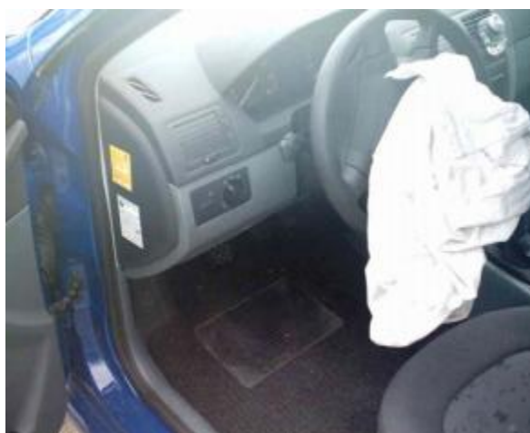
Слика 8 б. Ваздушни јастук након 0,5 s од удара
