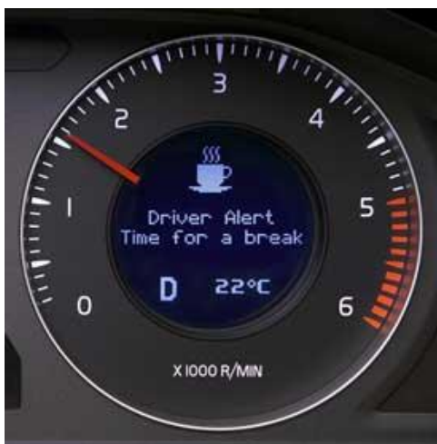
Слика 22. Упозоравање возача са симболом шољице за кафу
