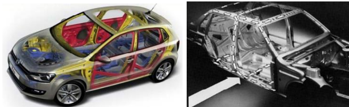
Слика 3. Ојачавање бочних делова каросерије уградњом специјалних стубова
