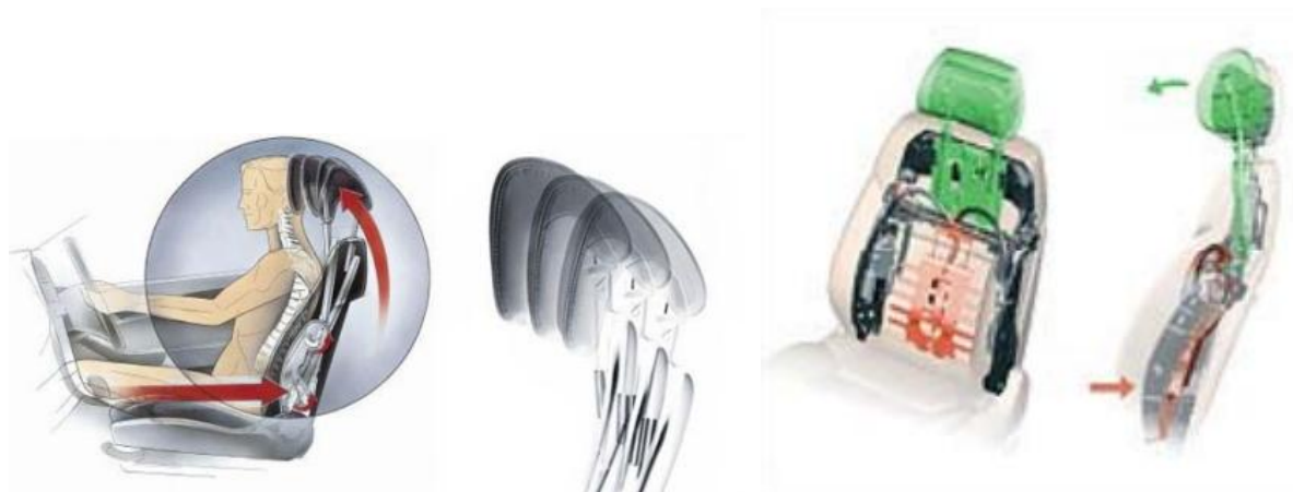
Слика 17. Систем Saab Active Head Restraint
