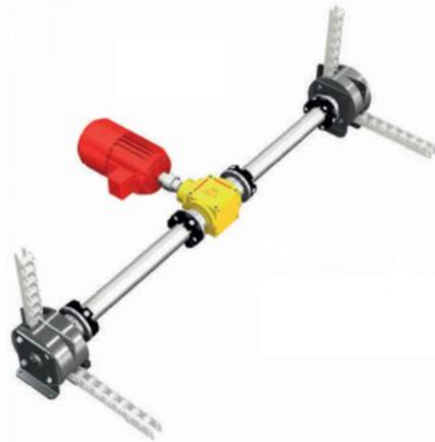
Слика 10 – Шема упаривања линеарног ланца са редуктором [8]
