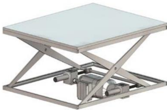
Слика – Платформа са „Screw Jack“ системом [6]
