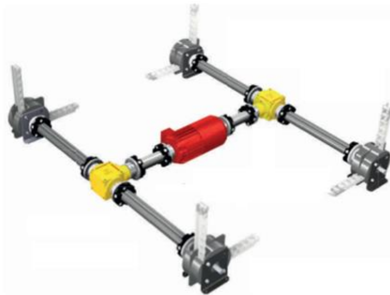
Слика 11 – Шема упаривања више линеарних ланаца [8]
