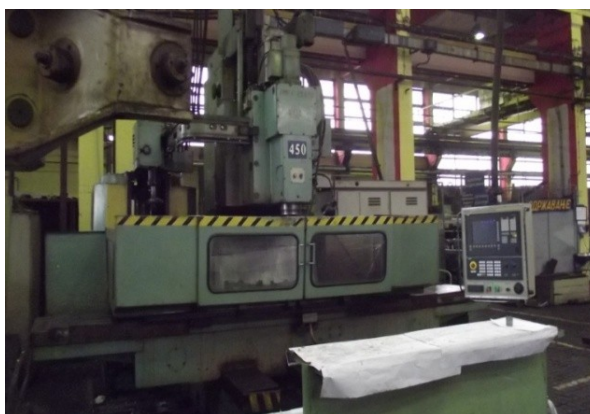
Слика 4.5: На сликама је приказан обрадни центар 65A90PMF4
