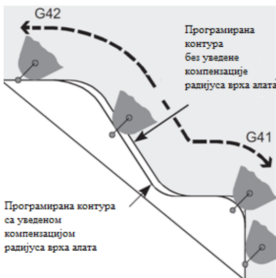
Слика 3.19: Компензација радијуса врха ножа за обраду закривљених и равних површина
