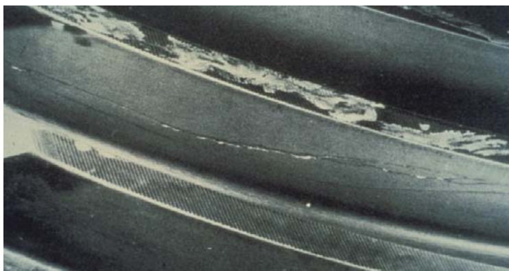
Слика 3.10. Оштећење изазвано великим преоптерећењем ( case crushing ) [24]
