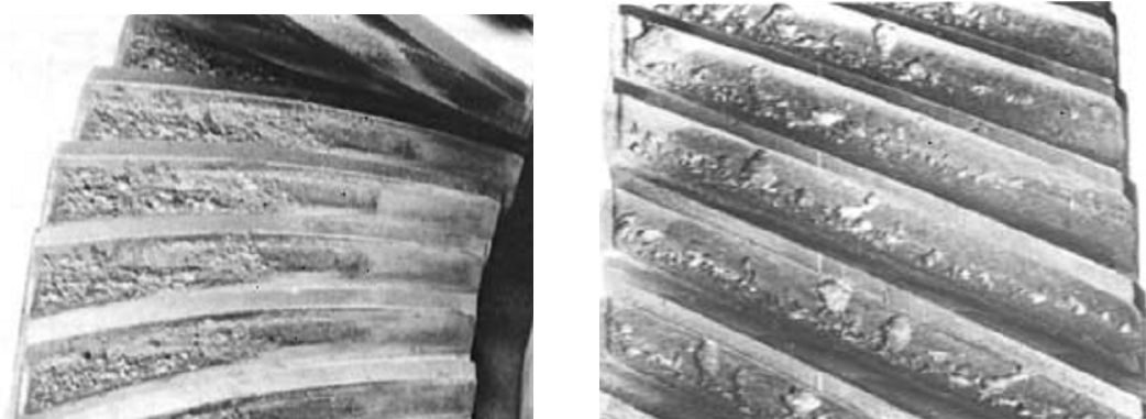
Слика 3.15. Разорни питинг код ојачаних зупчаника [23]
