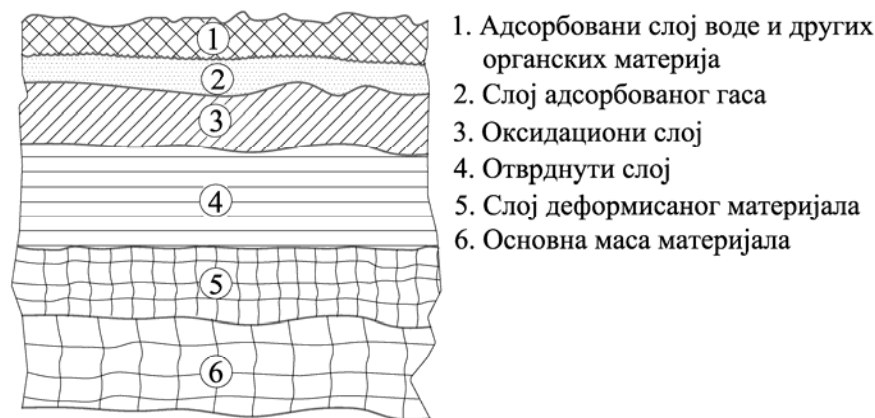
Слика 1.2. Структура површинског слоја чврстих тела [6]
