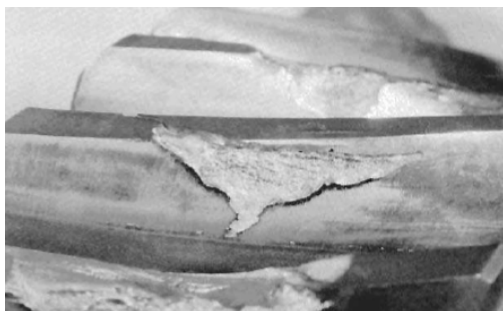
Слика 3.8. Иницијални питинг који је прерастао у тежи spalling [23]
