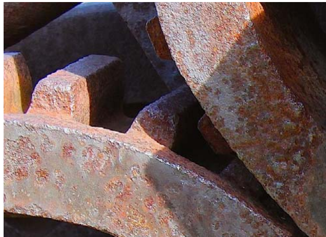
Слика 3.25. Изглед зупчаника којег је захватила оксидација [35]
