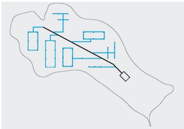
Слика 5.2 - Распоред сонди за прикупљање гаса [8]
