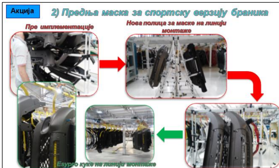
Слика 54 – Нова полица за одлагање предњих маски на линији монтаже
