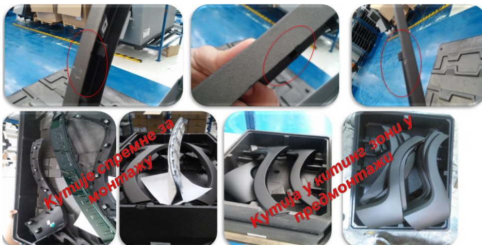
Слика 20—Ојачање за ивице браника (леви и десни) који се највише оштећују у процесу
