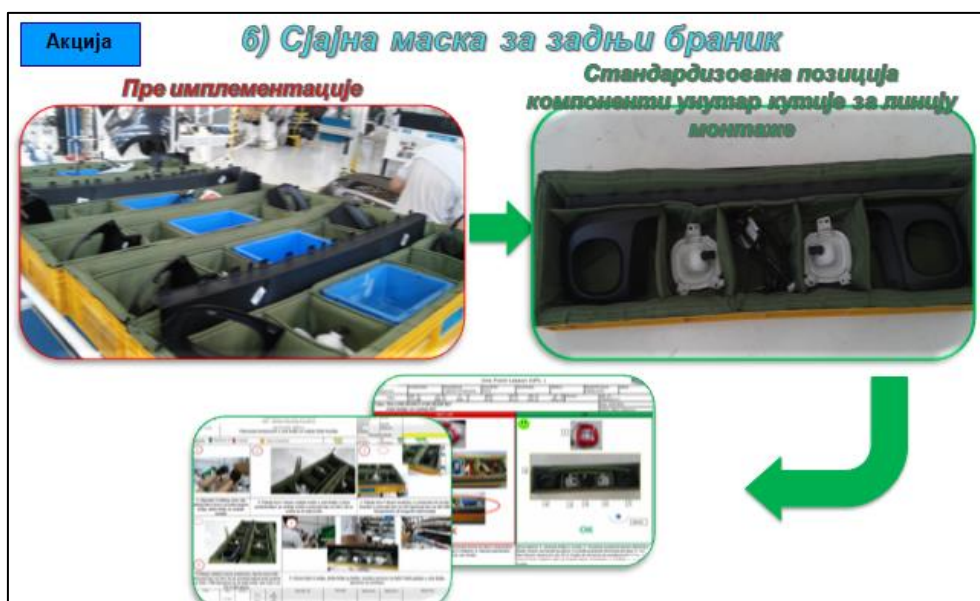
Слика 58 – Нове кутије за задњу линију монтаже и нова метода постављања компоненти унутар кутија
