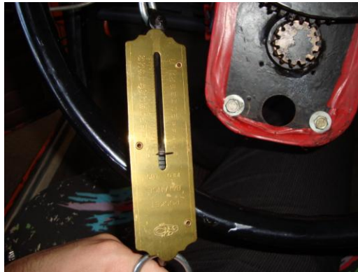
Слика 21: Динамометар постављен на точак управљача
