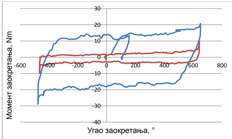
Слика 31: Зависност момента заокретања од угла заокретања за оба режима
