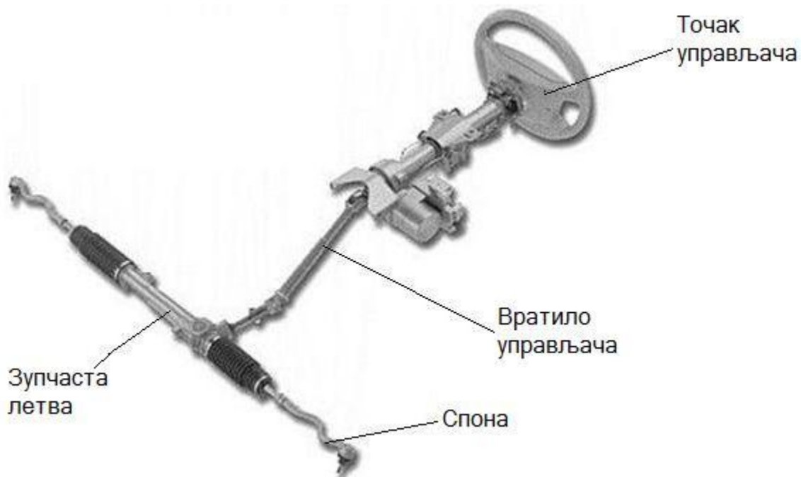
Слика 1: Склопови и подсклопови система за управљање (зупчаник-зупчаста летва) [3]
