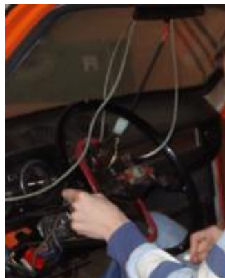
Слика 17: Динамометарски точак уграђен на возилу ZASTAVA 101
