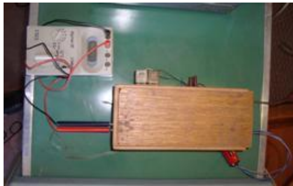
Слика 18: Постављен уређај за мерење вредности и угла заокретања у волтима
