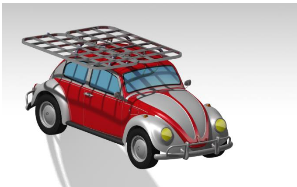
Слика 30: Изглед модела са платформом и причвршћивачима платформе на возилу
