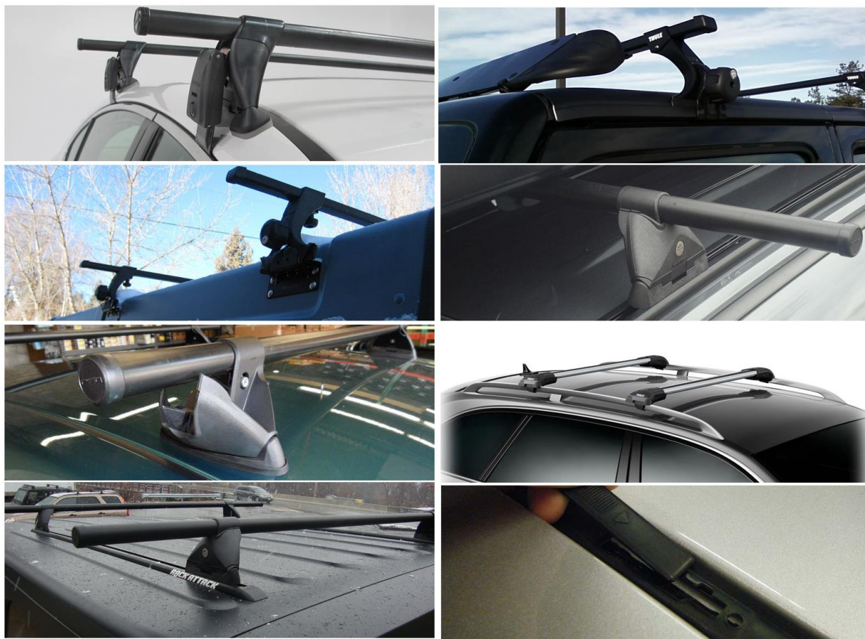
Слика 3: Кровни носачи и начини качења за каросерију возила. Слике преузете из [6]
