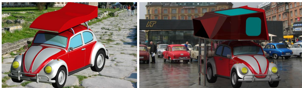
Слика 13: Предложен модел у склопљеном стању (лево) и расклопљеном стању (десно)
