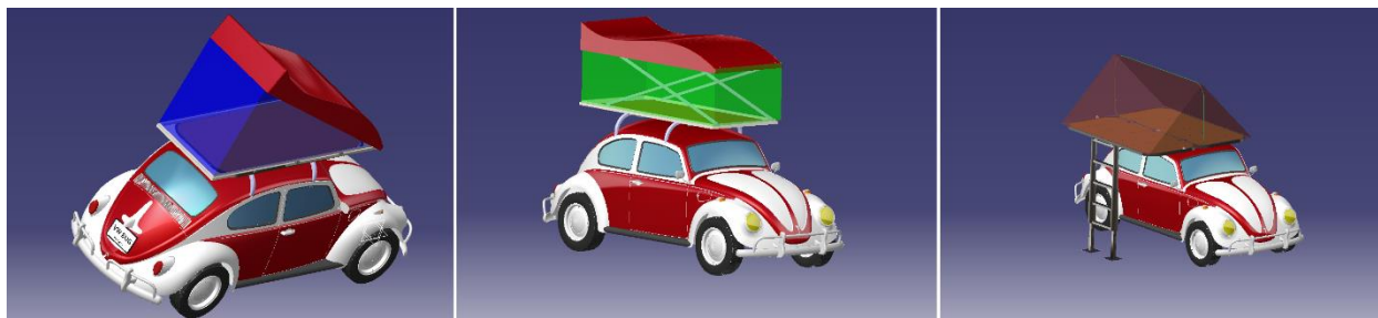
Слика 26 : (Лево и средина) концепција модела кровног носача шатора са тврдим кровом који се подиже вертикално навише/косо за једну особу ; (Десно) потпуно расклопиви кровни носач шатора са меким кровом за више особа
