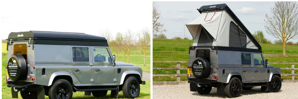
Слика 9: Накнадна уградња кровног шатора. Слика преузета са [16]
