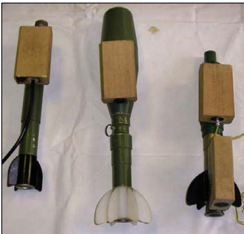
Слика 4.6 Уништавање тромблонских мина ТТМ М60, КТМ М60 и ТТМ са допунским пуњењем [46]
