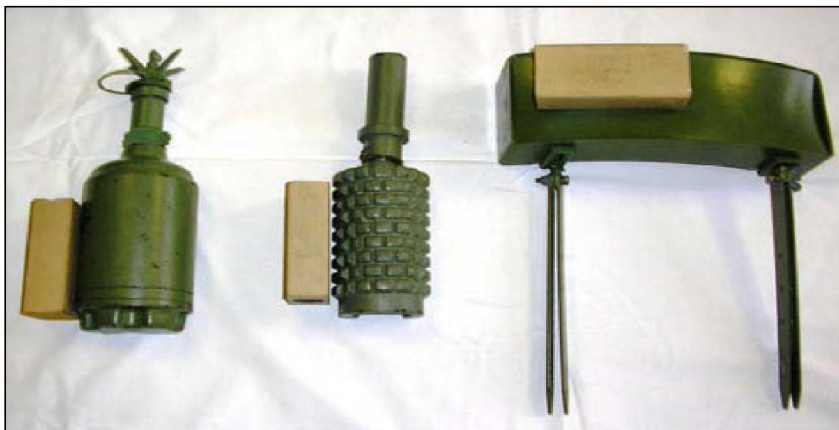
Слика 4.2 Постављање експлозивног набоја на противпешадијске распрскавајуће мине и МРУД ПРОМ-1, ПМР-2АС и МРУД [46]
