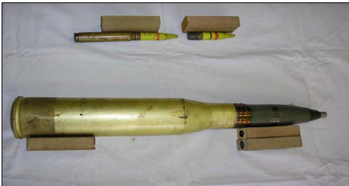
Слика 4.10 Метак са ТЗОГ и артиљеријски метак Горе: 20 mm метак са ТЗОГ, 20 mm ТЗОГ Доле: Артиљеријски метак позиције е/н [46]
