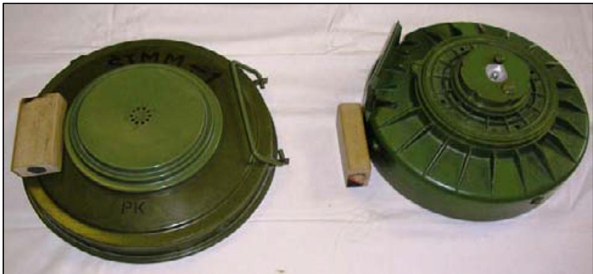
Слика 4.3 Позиције постављања експлозивног метка на противоклопне мине ТММ-1 и ТМРП-6
