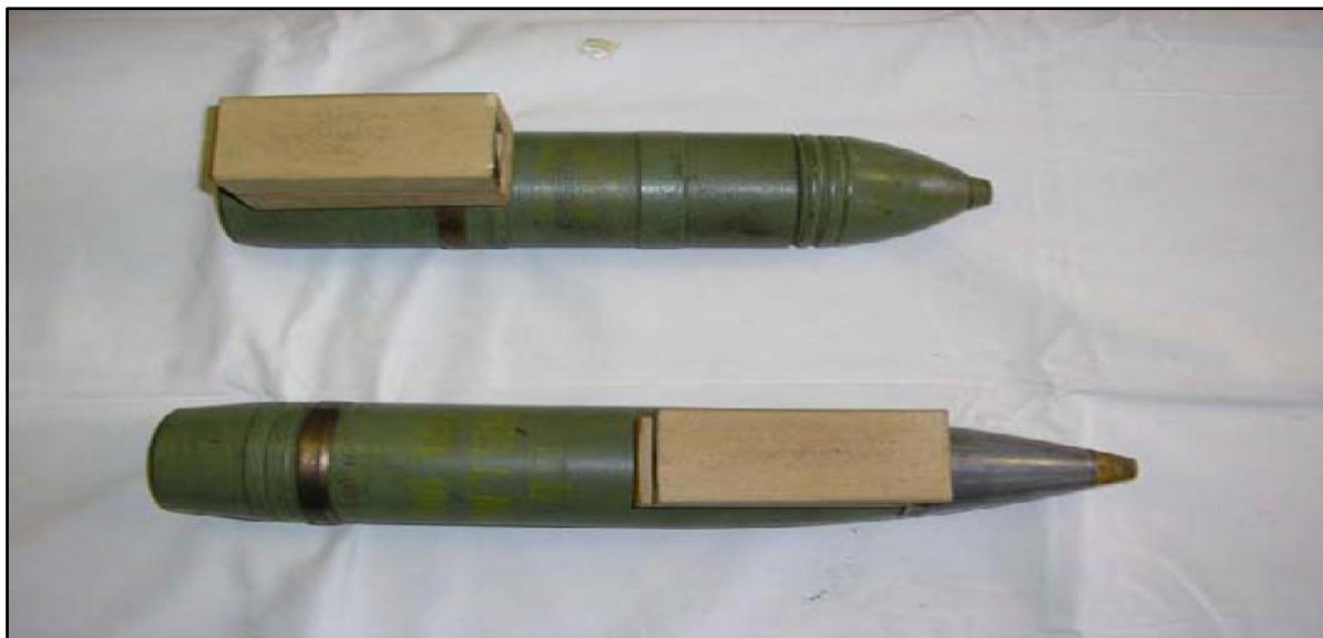
Слика 4.9 Уништавање кумулативног зрна и граната Кумулативно зрно (горе) ТФ граната (доле) [46]
