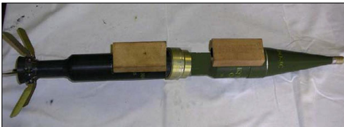
Слика 4.14 Позиције постављања експлозива уколико ракетни мотор није изгорео [46]
