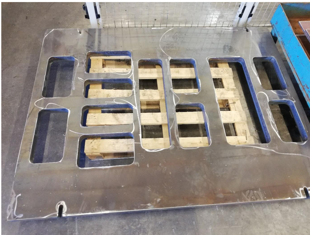
Слика 12. Исечен део који је спреман за следећи корак (склапање)
