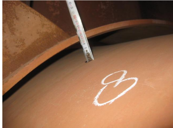
Слика 11. Прслина уочена визуелним испитивањем (лево), зазор на сателиту пећи клинкера (десно)
