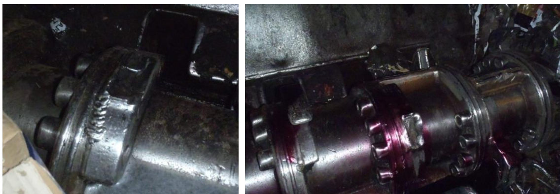
Слика 55. Одмашћена и очишћена површина која се испитује (лево), извршено наношење пенетранта на испитивану површину (десно).
