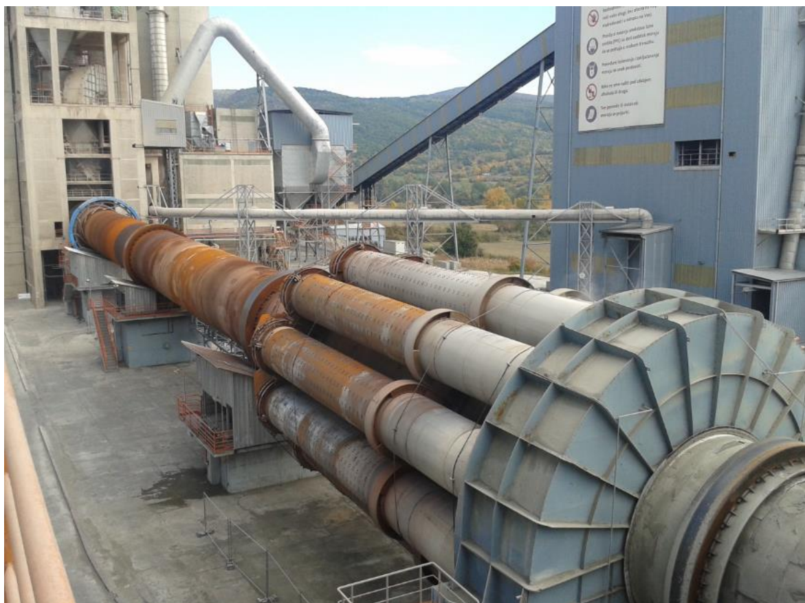
Слика 52. Пећ клинкера са планетарним хладњаком
