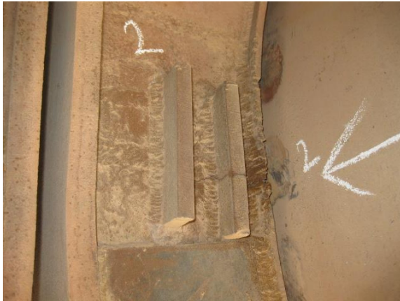
Слика 11. Прслина уочена визуелним испитивањем (лево), зазор на сателиту пећи клинкера (десно)
