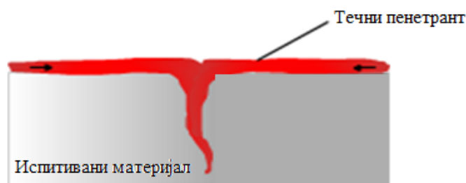
Слика 16. Примена и деловање пенетранта
