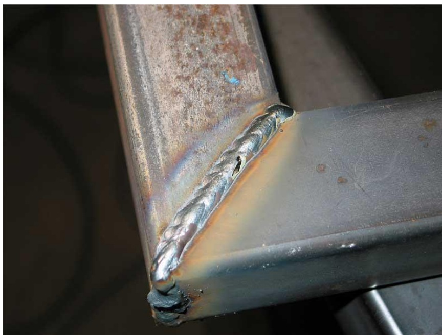
Слика 50. Грешка на вару завареног споја уочена визуелном методом испитивања
