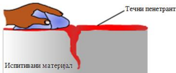
Слика 17. Уклањање вишка пенетранта
