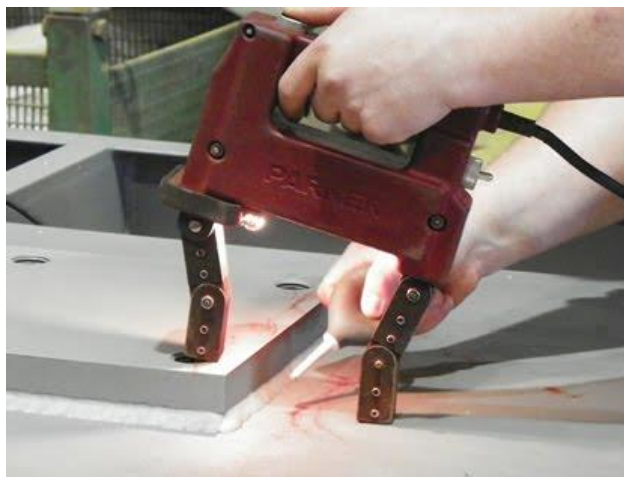
Слика 63. Превентивно испитивање завареног споја магнетном методом
