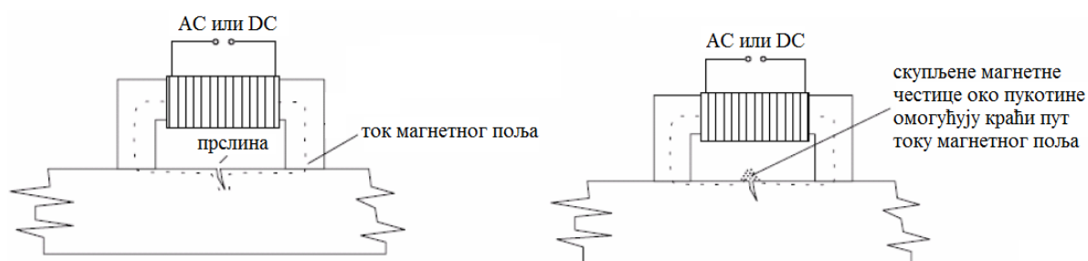
Слика 61. Схематски приказ принципа испитивања магнетним честицама
