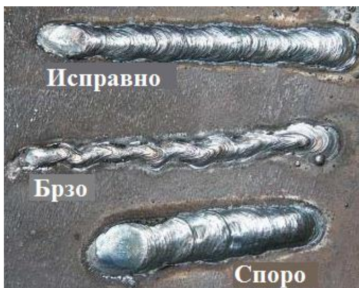
Слика 51. Квалитет вара у зависности од брзине заваривања
