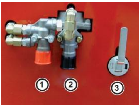
Слика 17 – Кочни вентил (1 - активирање паркирне кочнице, 2 - активирање радне кочнице, 3 - регулатор кочионе силе)
