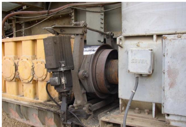
Слика 13 – Механичке кочнице у електромоторном погону [6]
