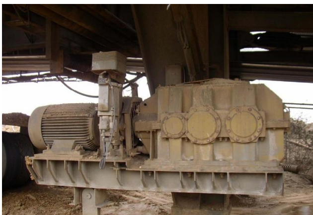
Слика 13 – Механичке кочнице у електромоторном погону [6]
