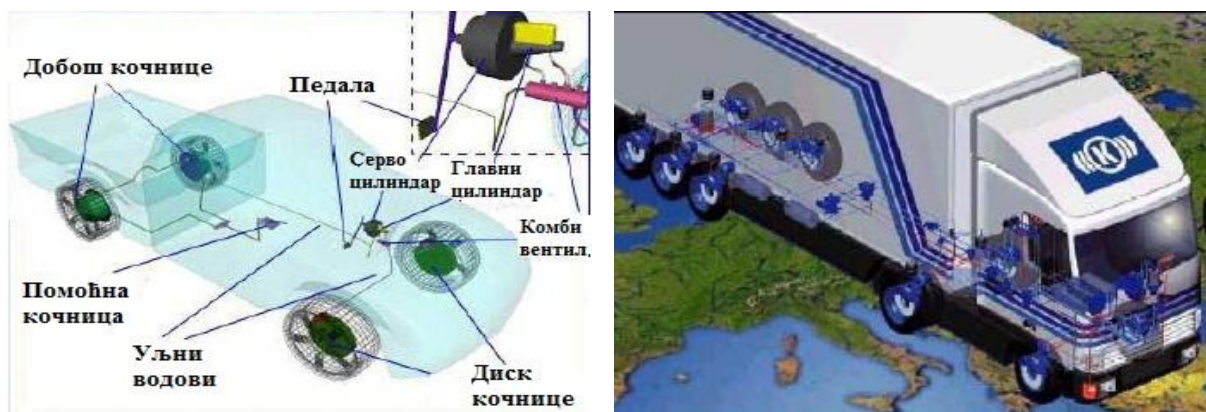
Слика 1 – Распоред кочионог система у путничком (лево) и привредном (десно) возилу
