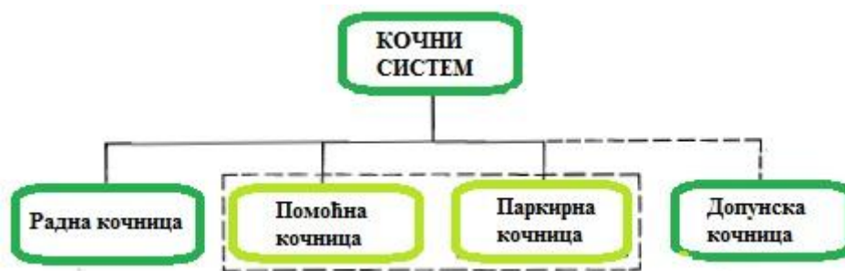
Слика 3 – Шематски приказана структура кочног система
