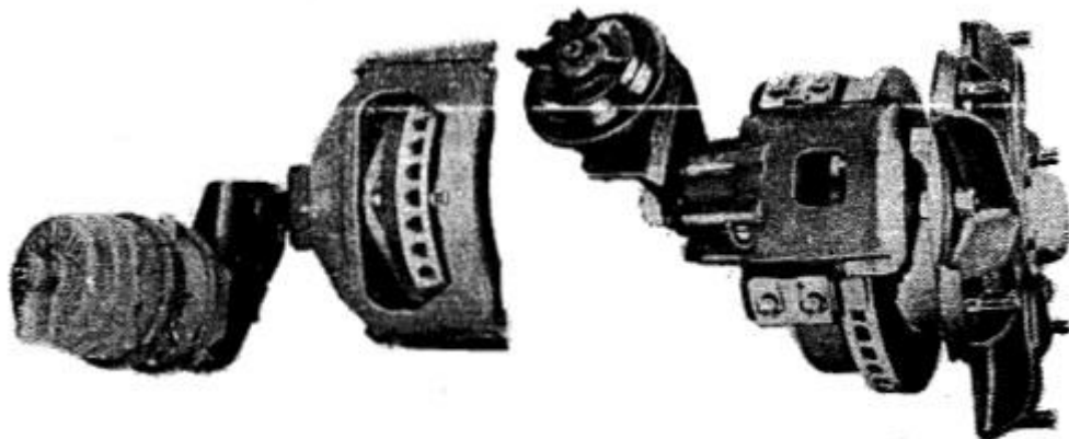
Слика 41 – Развој диск кочница, фирме BENDIX (лево) и фирме KELSEY HAYES (десно)
