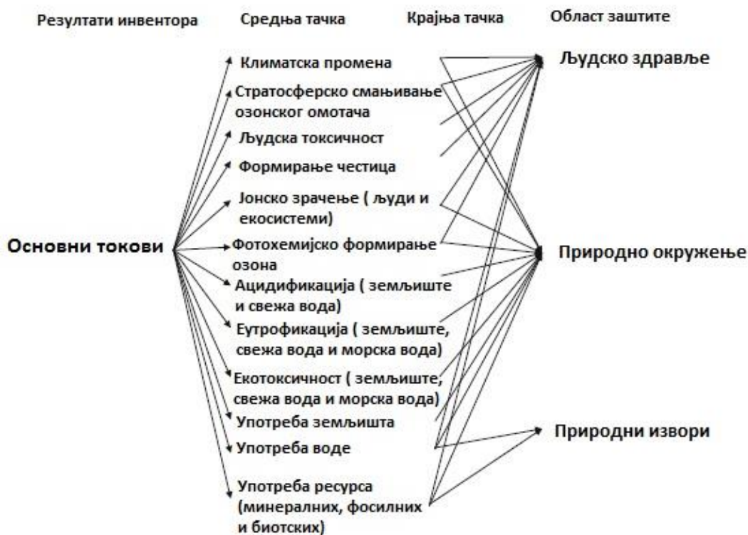
Слика 2. Оквир ILCD карактеризације који повезује елементарне токове из резултата инвентора са резултатима индикатора средње и крајње тачке за 15 категорија утицаја и 3 области заштите [5]
