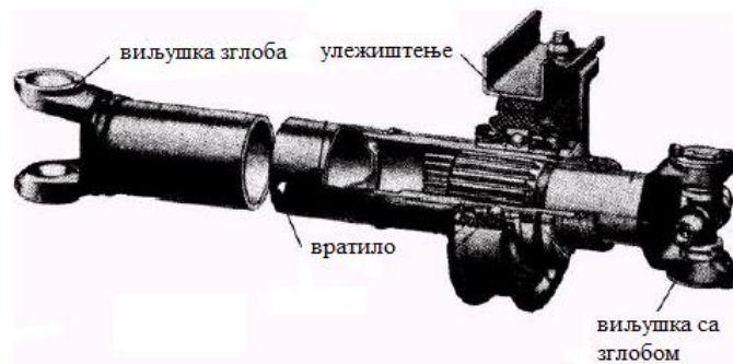
Слика 2.4 Главни подсклопови асинхронног зглобног вратила уграђеног са међулежајем [3]
