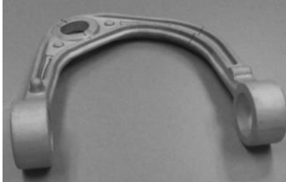
Слика 4.18 Прототип магнетне контролне ручице коју је произвео General Motors користећи поступак ливења под ниским притиском ( LPDC )
