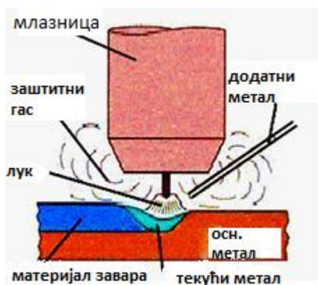
Слика 4.1 Принцип TIG заваривања
