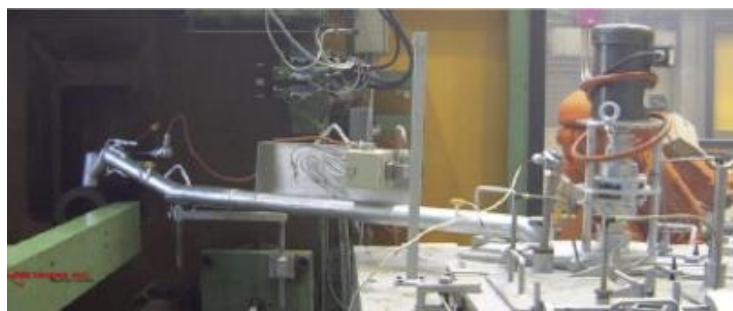
Слика 4.12 Метална цев за пренос истопљеног магнезијума у машину за ливење
