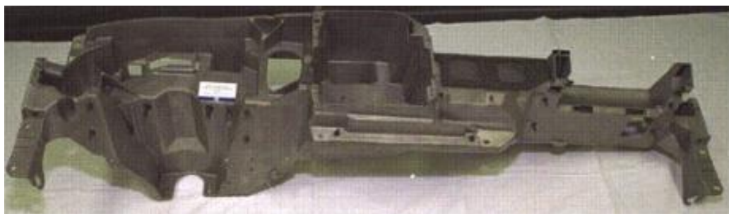
Слика 4.16 Једноделни носач инструмент табле за Chevrolet Ekspress (12,3 kg )
