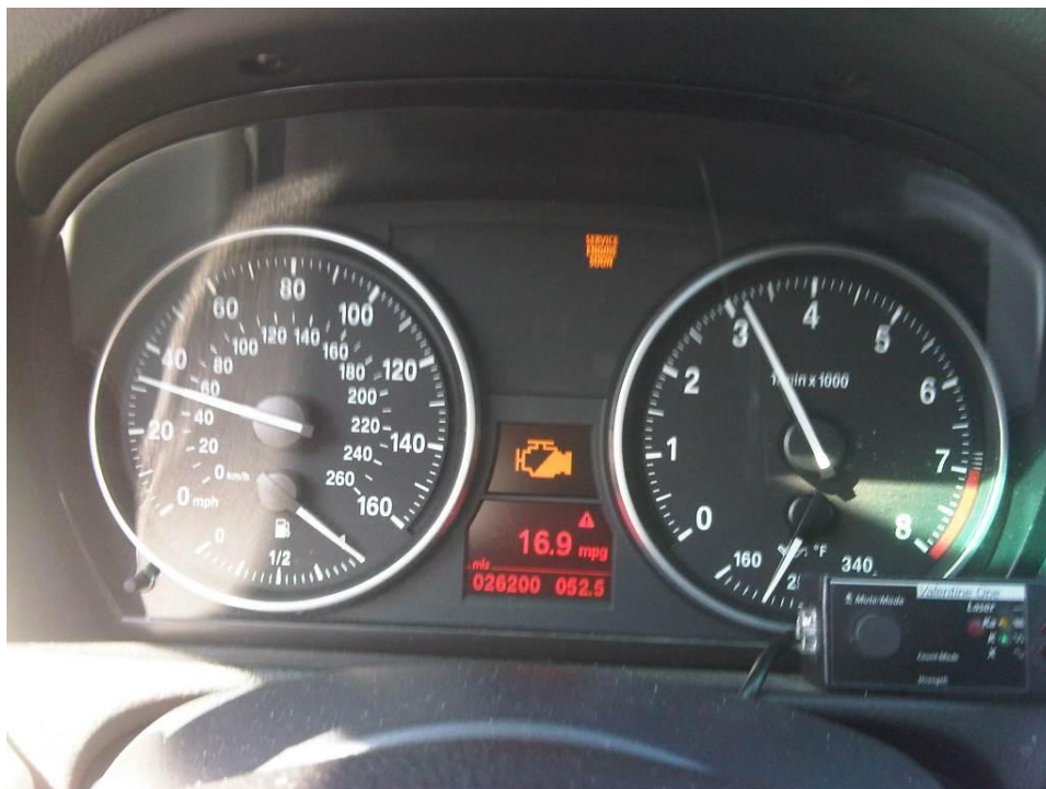
Слика 3. MIL лампица место уградње и облик
