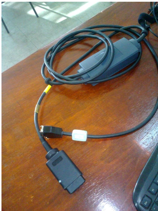
Слика 5. Изглед OBD II прикључка и адаптерске кутије OBD-a II
