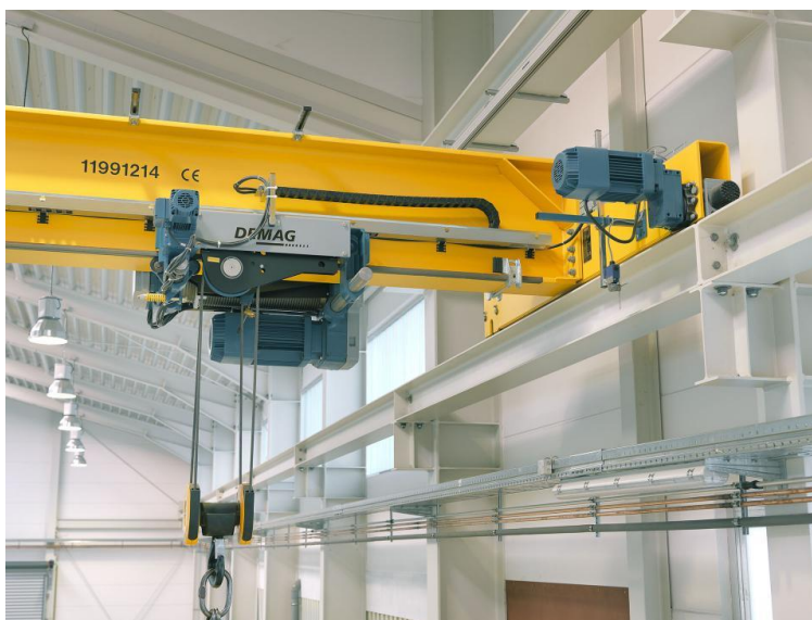
Слика 4.5. Једногредна насадна мосна дизалица са носачем од ваљаних профила [24]
