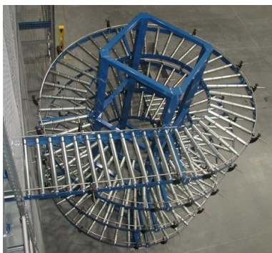
Слика 2.26. Гравитациони уређај-ваљкасти транспортер без погона [20]
