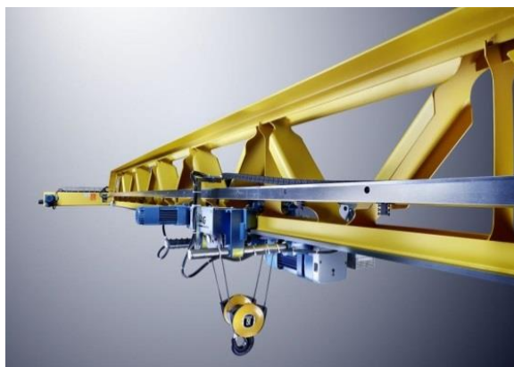
Слика 4.7. EVKE дизалица са V извођењем главног носача [24]
