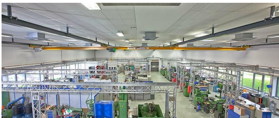
Слика 4.22. Једногредна висећа дизалица са четири кровне греде која превози делове машина и прототипове [25]
