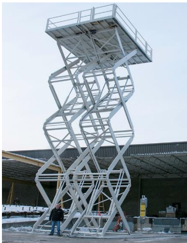
Слика 2.12. Подизач са платформом без сопственог погона [6]
