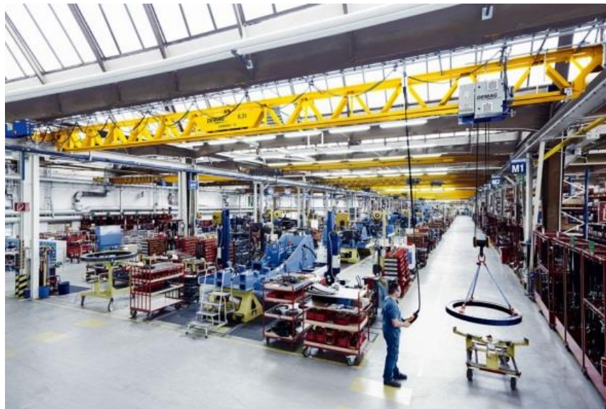
Слика 4.8. EVKE дизалица са V извођењем главног носача [24]
