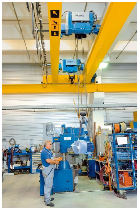
Слика 4.14. ZKKE двогредна мосна дизалица са два механизма за дизање [24]
