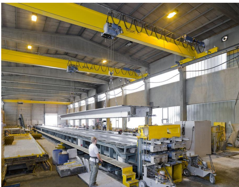
Слика 4.2. Једногредна насадна мосна дизалица са кутијастим главним носачем [24]
