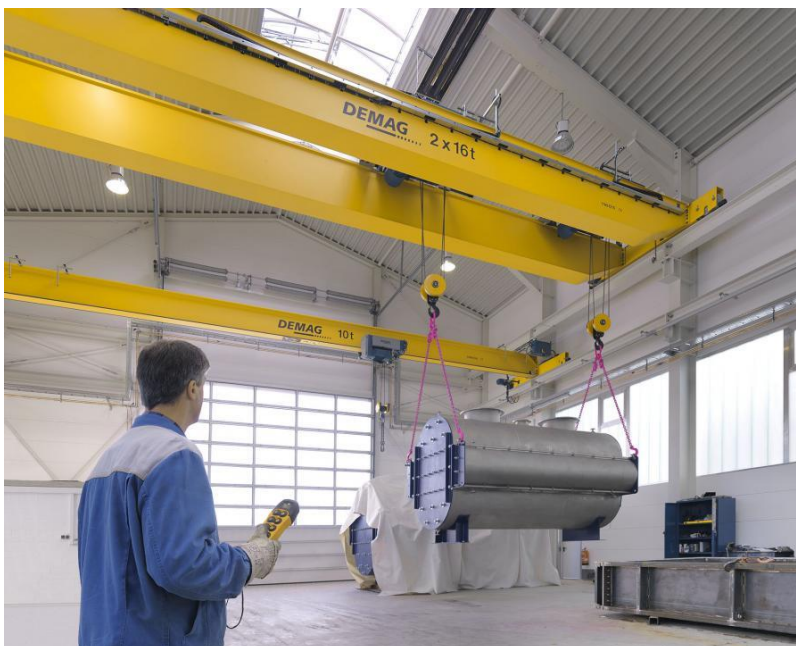
Слика 4.13. ZKKE двогредна мосна дизалица [24]
