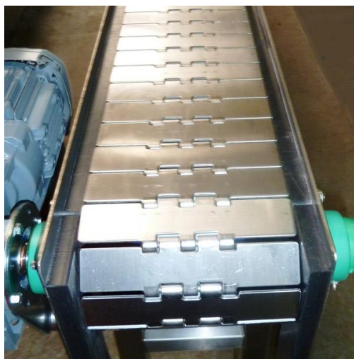
Слика 2.15. Плочасти транспортер [9]
