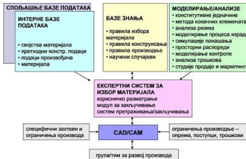
Слика 2.5 Основни модули CAMS експертног система
