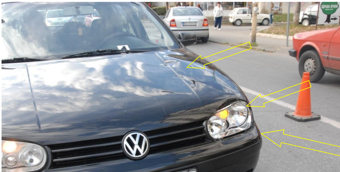
Слика 6.3 – Трагови брисања и оштећења на возилу голф
