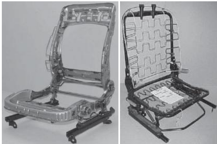
Слика 4.3. а) носећа структура седишта добијене пресовањем металних делова, б) носећа структура седишта добијена спајањем греда различитог попречног пресека [4]
