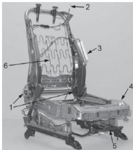
Слика 4.4. Елементи носеће структуре седишта: 1. механизам за подешавање наслона седишта, 2. кабл за контролу отпуштања седишта, 3. троакална бочна торба, седални део са системом ослањања, 5. механизам за подешавање седишта по хоризонтали, 6. жицане опруге наслона [4]
