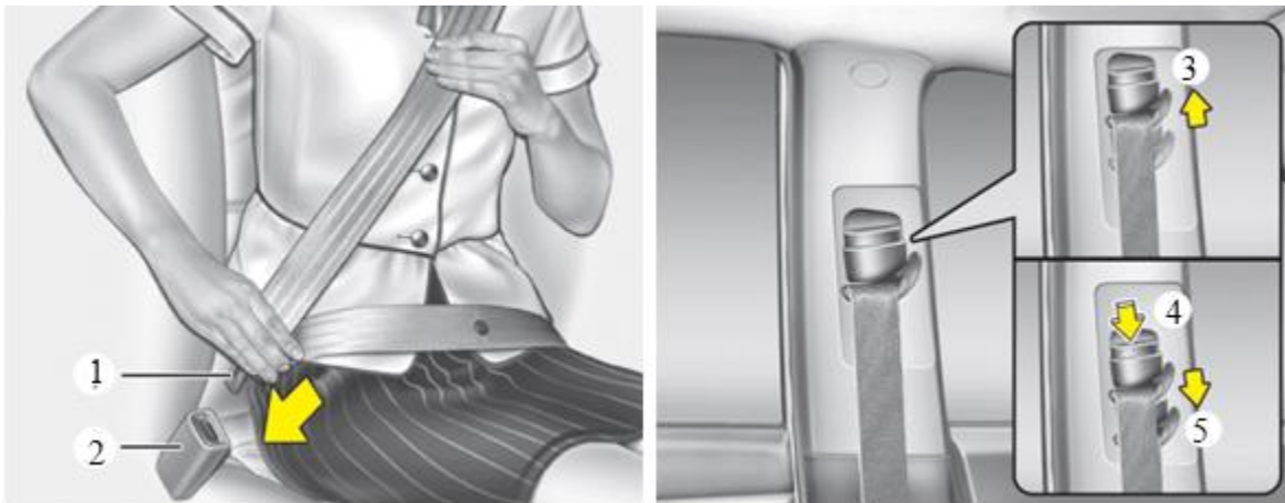
Слика 4.5. Традиционална седишта: 1. сигурносни појас, 2. прикључак, 3. стуб, 4. и 5. механизам за подешавање висине појаса [7]
