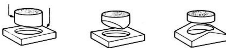
Слика 5.26 – Изглед радних елемената алата са косим резним ивицама [1]
