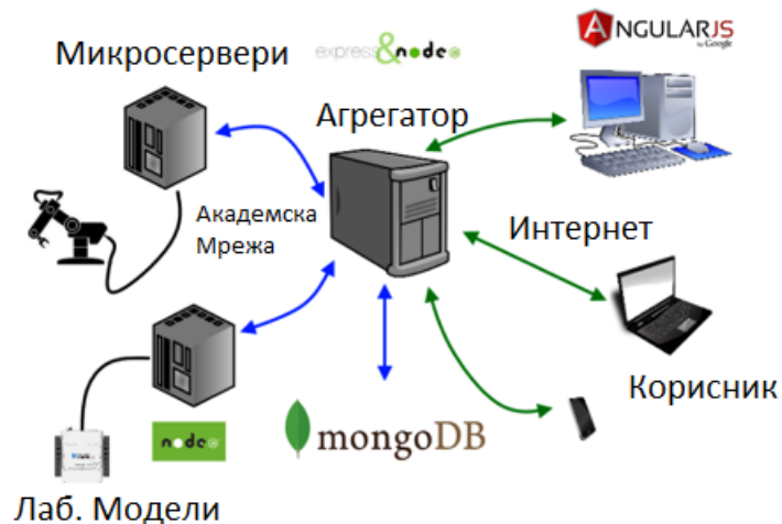
Сл. 3.7: Поједностављен дијаграм удаљене лабораторије
