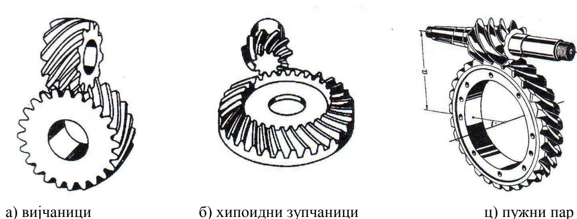
Слика 1.2. Хиперболоидни зупчасти парови [1]
