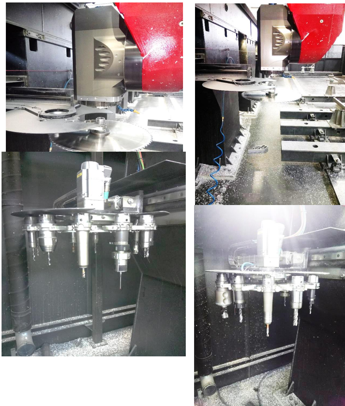
Слика 64. Аутоматско позивање алата и магацин са 12 алата
