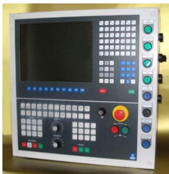
Слика 9. Пример нумеричке управљачке јединице [31]
