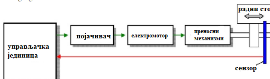
Слика 18. Затворени мерни систем [58]
