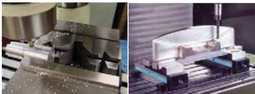
Слика 30. Причвршћивање обрадка (1) и Т-жљебови (2) [38]
