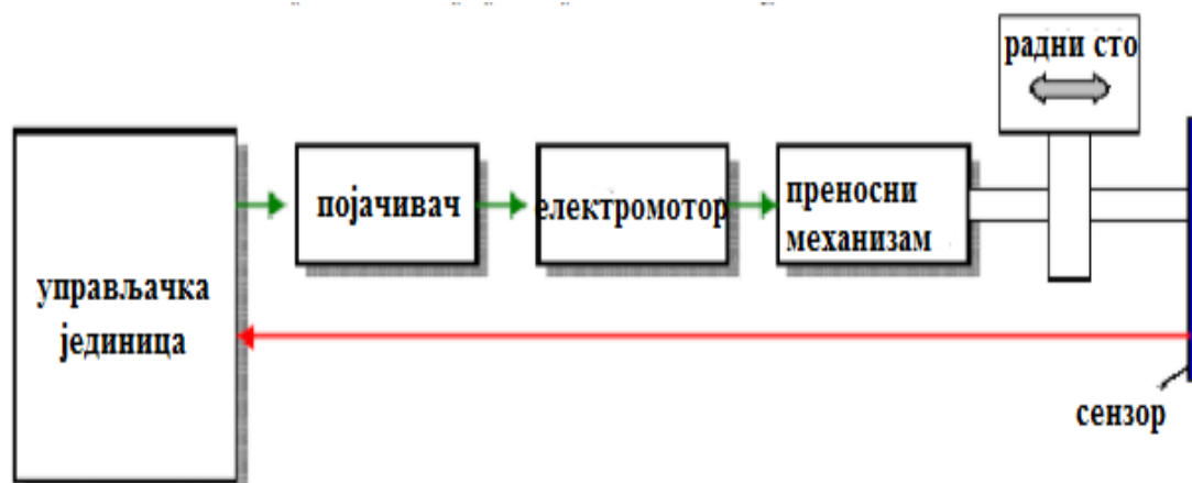
Слика 19. Полузатворени мерни систем [58]
