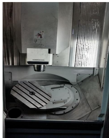
Слика 43. Вишеосна обрада на окретно нагибном столу [56]
