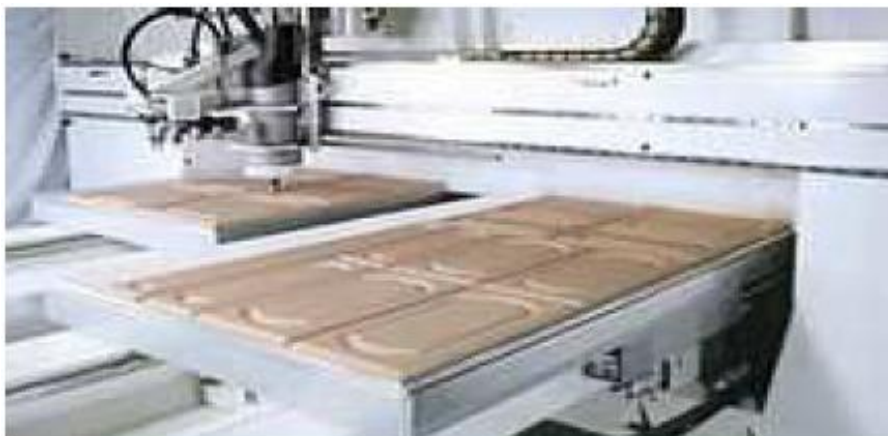
Слика 38. Обрада на два вишенаменска стола [44]
