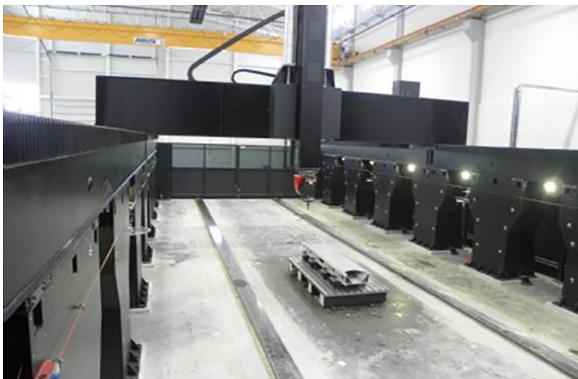
Слика 58. Унутрашњост петоосне глодалице SAHOS POWER TURBO
