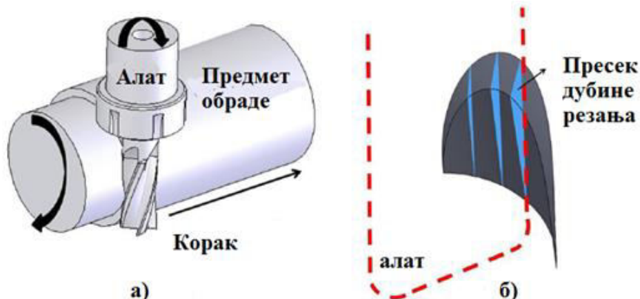
Слика 33. а) Тангентно стругање ротационим алатима и б) дубина резања (Zhu 2016)
