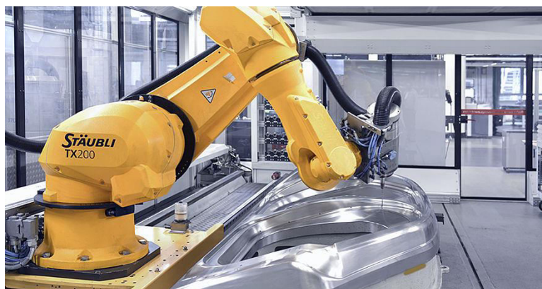
Слика 17. Артикулисани робот HSM поступку обраде у (www.staubli.com ,2020)
