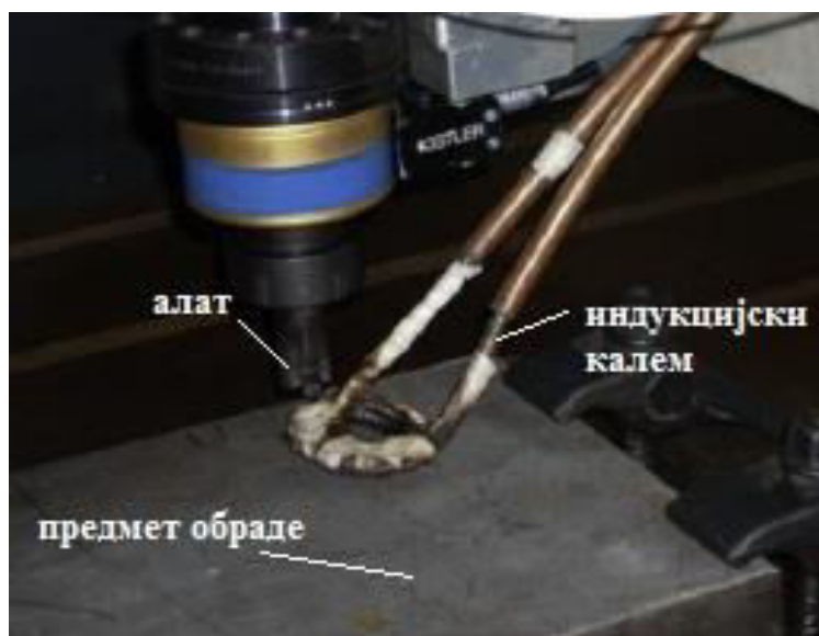
Слика 48. Индукцијски калем у зони предмета обраде (Manufacturing and Materials Engineering Department, IUM, Malaysia, 2009.)
