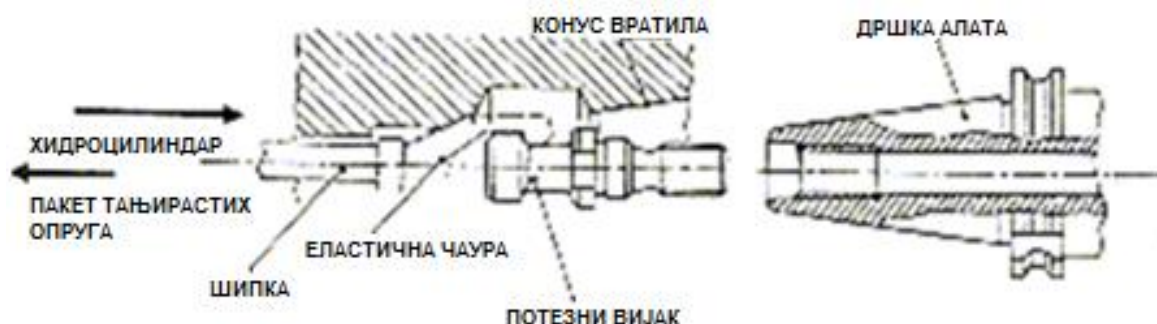
Слика 6.15. Задржавање дршке алата у конусу вратила помоћу еластичне чауре [12]
