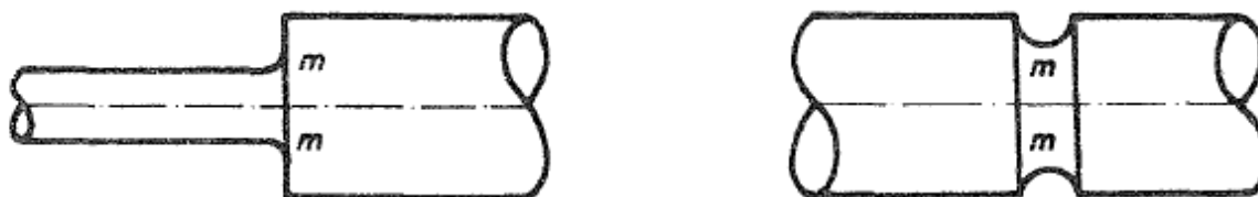
Слика 2.4.2 Торзија код греде са наглом променом попречног пресека [6]
