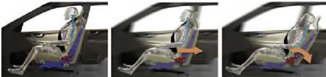
Слика 44. Систем Saab Active Head Restraint (SAHR)
