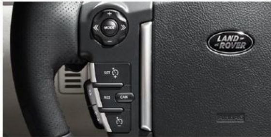
72: Изглед дугмади на волану за подешавање ACC и подешавање темпомат путем ручице
