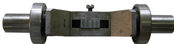
Слика 5.3. Ротирајући носач блока на трибометру TR-95 [24]
