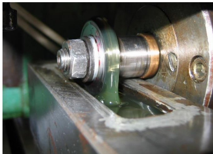
Слика 5.9 Довођење мазива у зону контакта ротацијом диска
