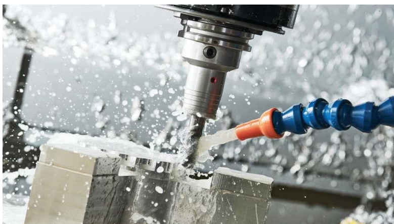
Слика 4.7 Довођење средстава за хлађење у зону резања[18]
