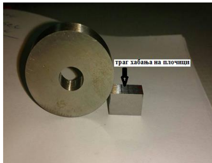
Слика 5.8 Приказ триболошког пара плочице од челика Š 4732 и диска Š 3840
