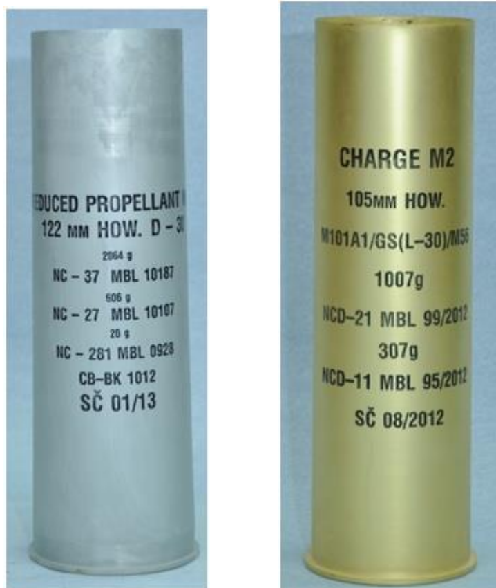
Слика 35, Обележавање чауре калибра 122 mm и 105 mm
