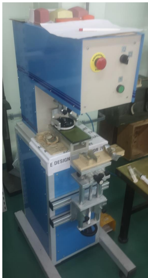
Слика 30, Машина за тампон обележавање
