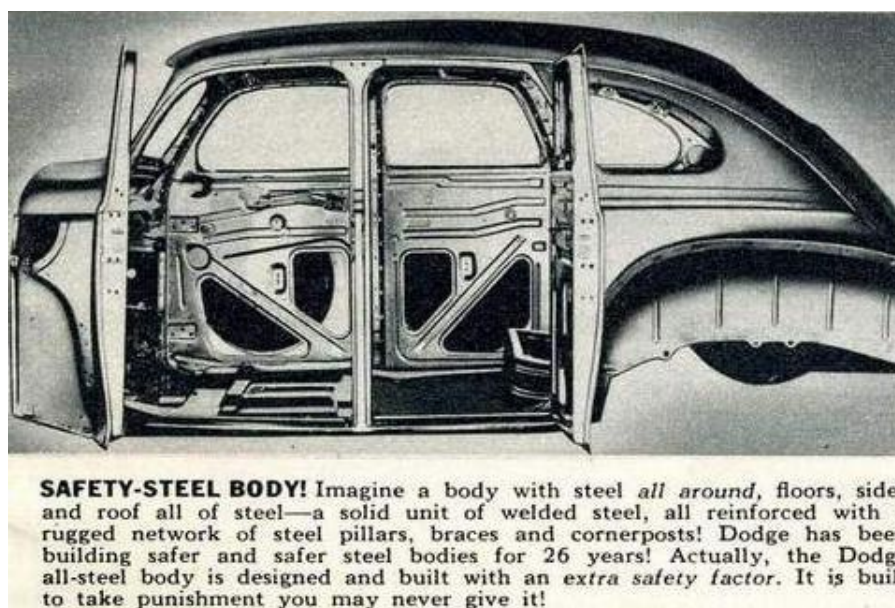
Слика 3.9 Безбедна челична каросерија Доџовог модела из 1940.године [5]
