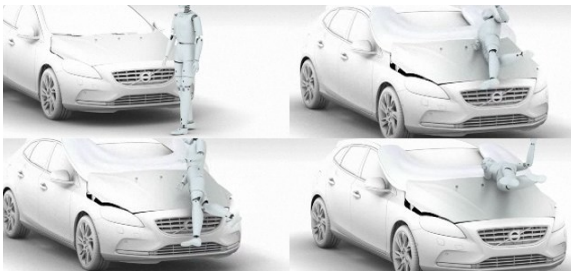
Слика 3.50 Ваздушни јастук за пешака на возилу Volvo V40
