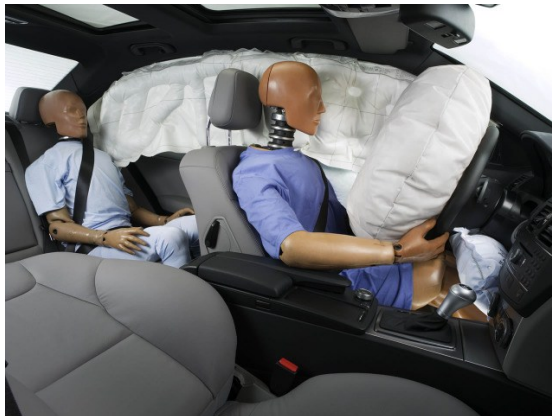
Слика 3.47 Активирање бочних ваздушних јастука
