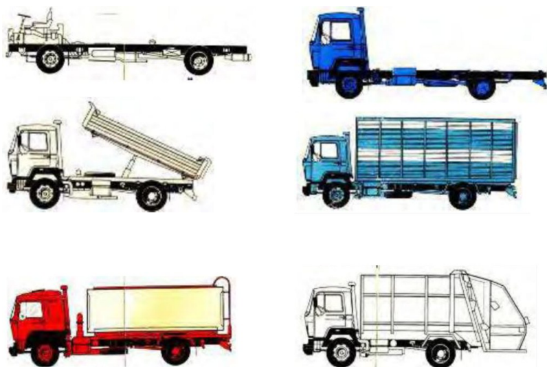
Слика 3.5 Различите надградње на истом раму шасије савременог теретног возила [4]
