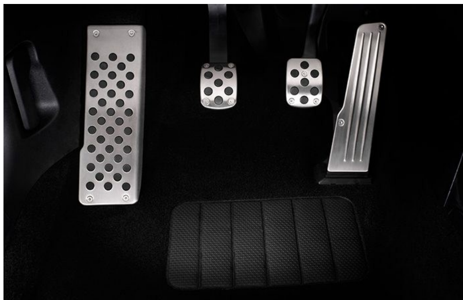
Слика 3.57 Педале које се померају приликом судара [29]
