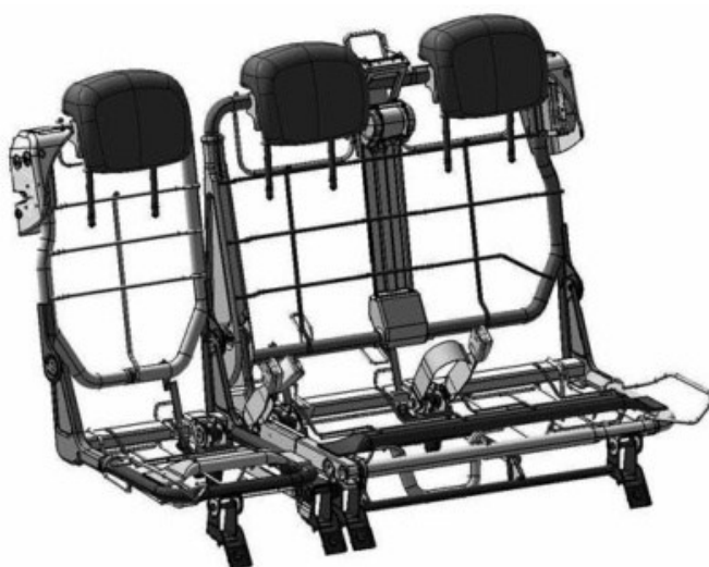
Слика 3.27 Приказ изгледа конструкције задњих седишта
