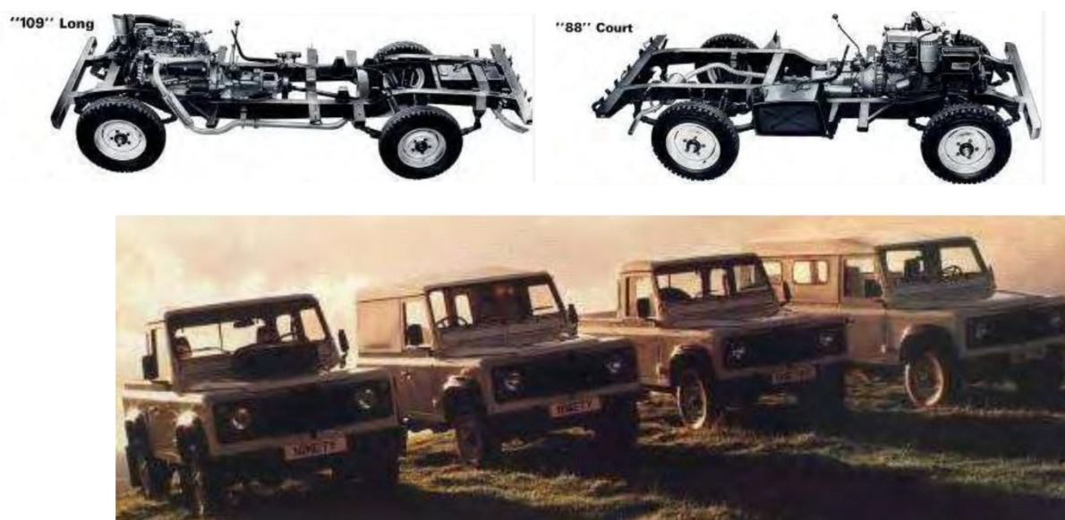
Слика 3.7 Каросерија са делимично интегрисаним рамом шасије возила Land Rover [4]
