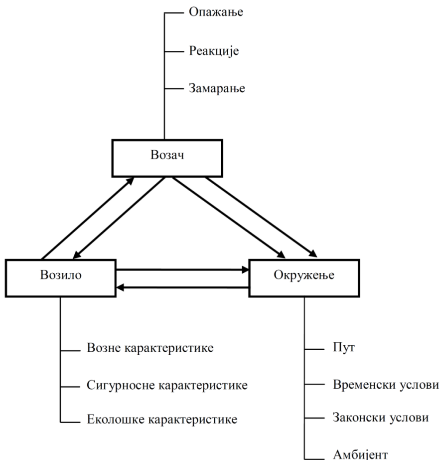
Слика 2.1 Упрошћени модел система возач-возило-окружење [1]
