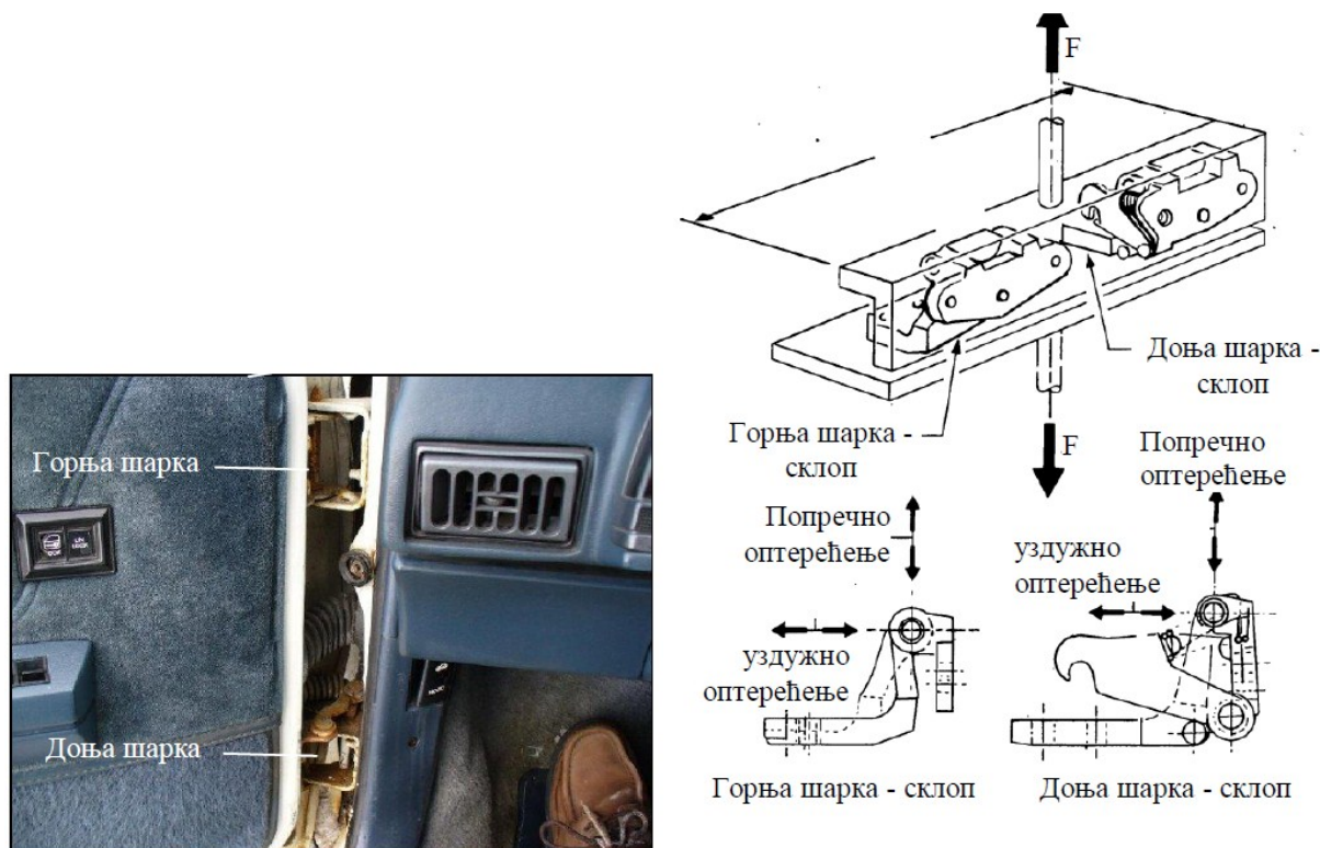
а) склопови шарки монтирани на каросерију б) принцип једног испитивања шарки
