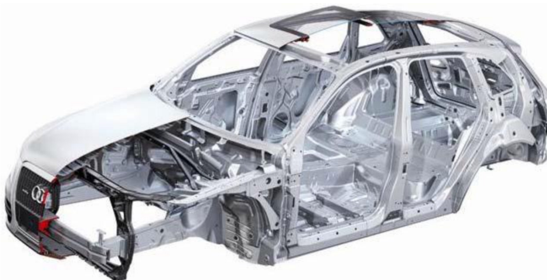
Слика 3.10 Пример носеће структуре каросерије аутомобила Audi Q5 [7]
