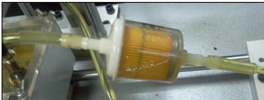
Слика 10.3 Механизам за издвајање честица из уља - филтер
