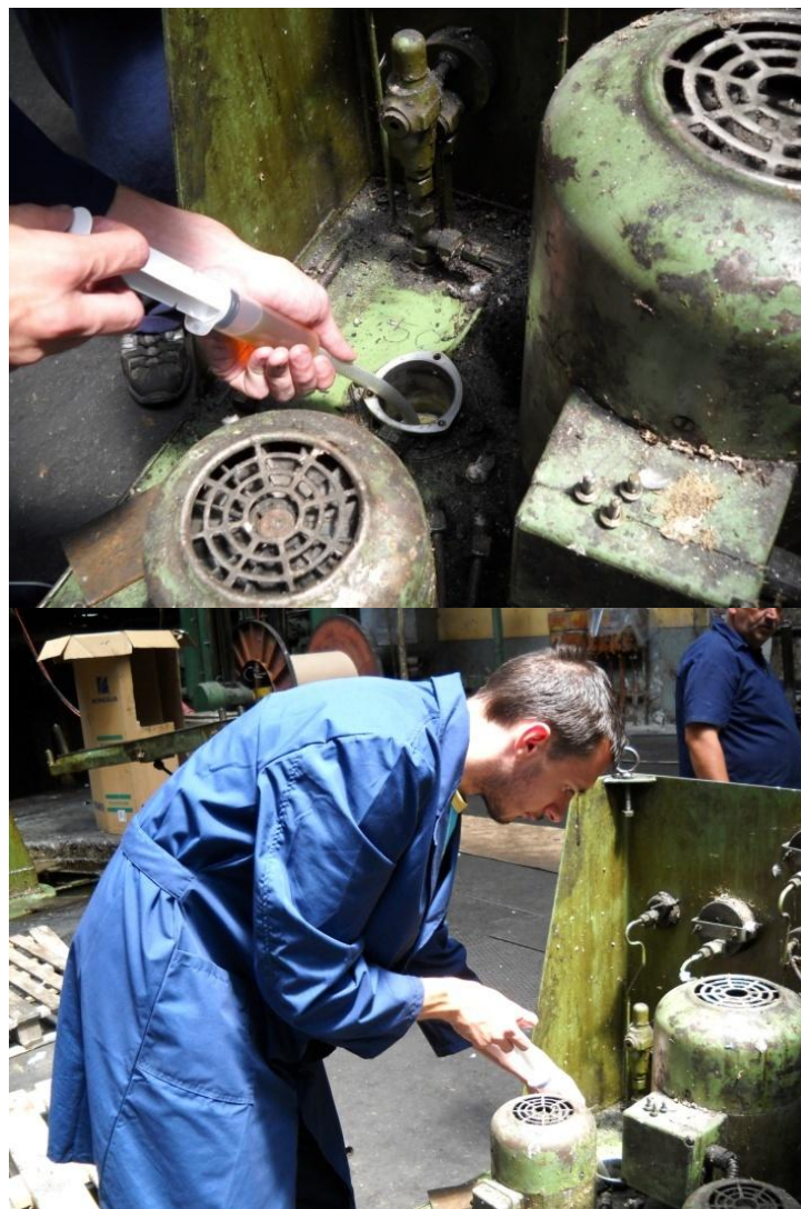
Слика 9.3 Узорковање хидрауличког уља из машине за превлачење каблова оловом
