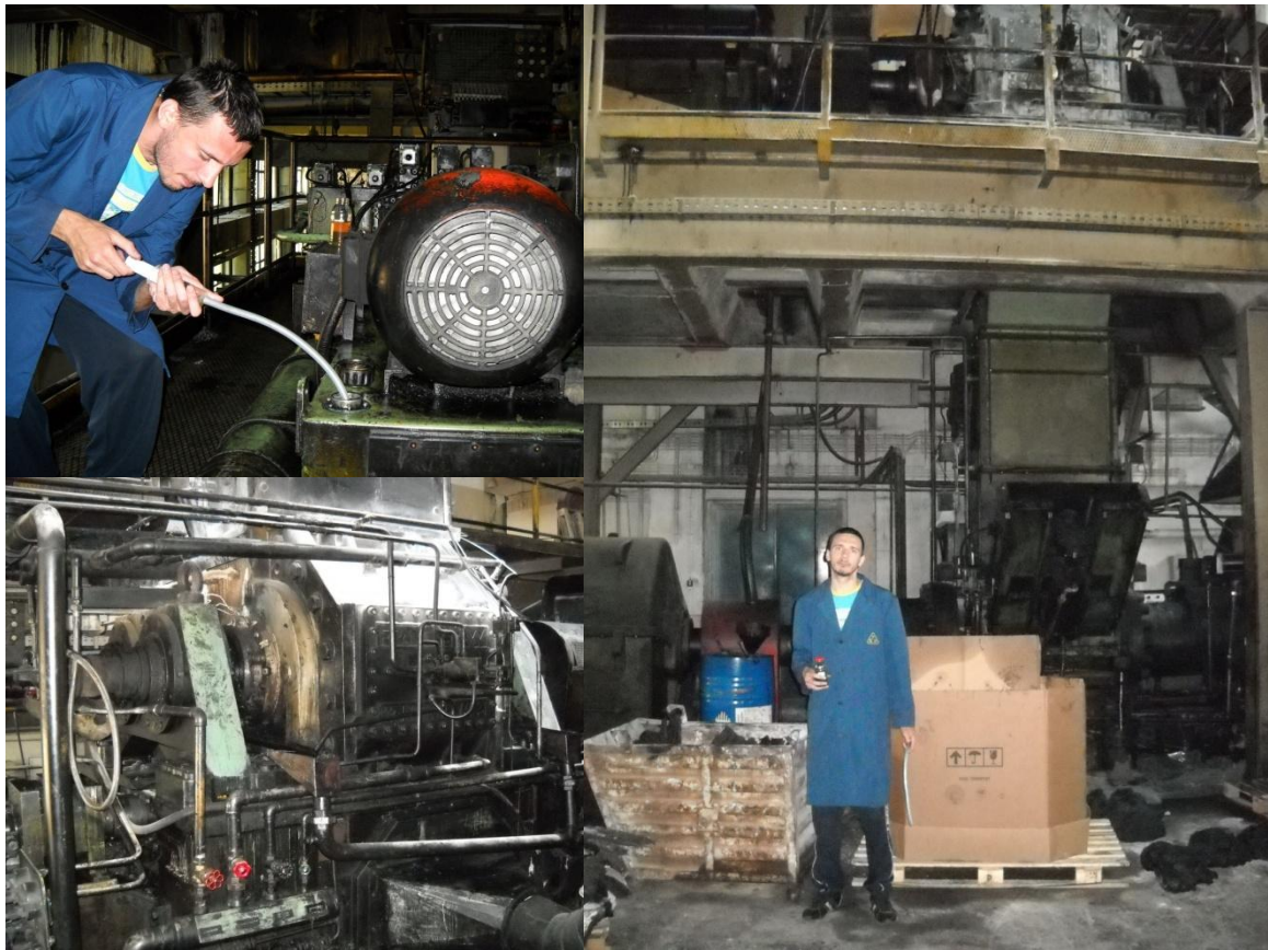
Слика 9.4 Узорковање хидрауличног уља из машине за наношење гуме на каблове
