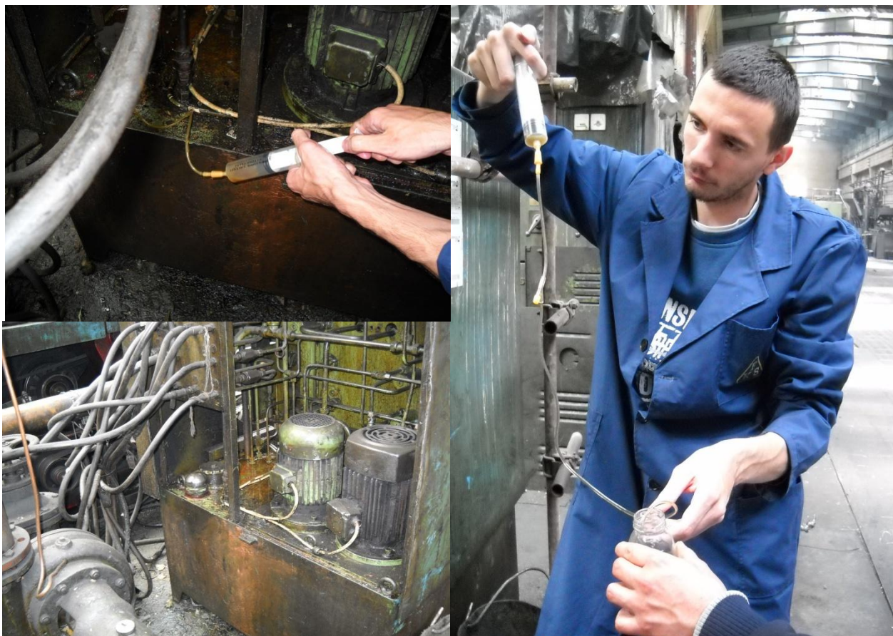
Слика 9.2 Узорковање хидрауличког уља из машине за грубо извлачење бакра
