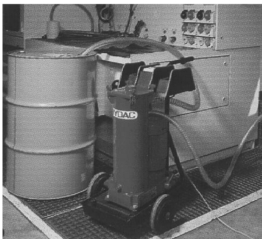
Слика 7.3 мобилни агрегат за пуњење хидрауличких система
