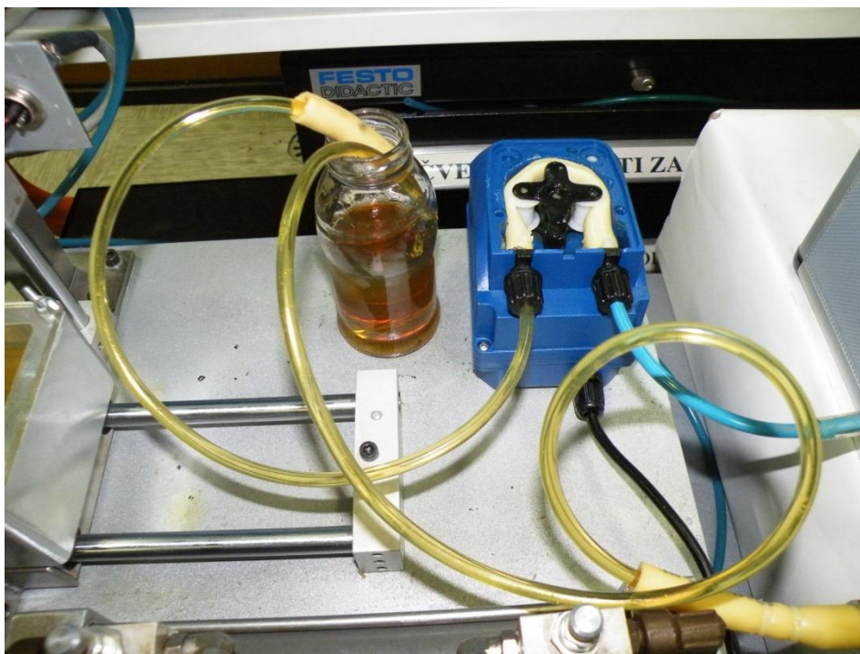
Слика 10.2 Уливање уља у уређај
