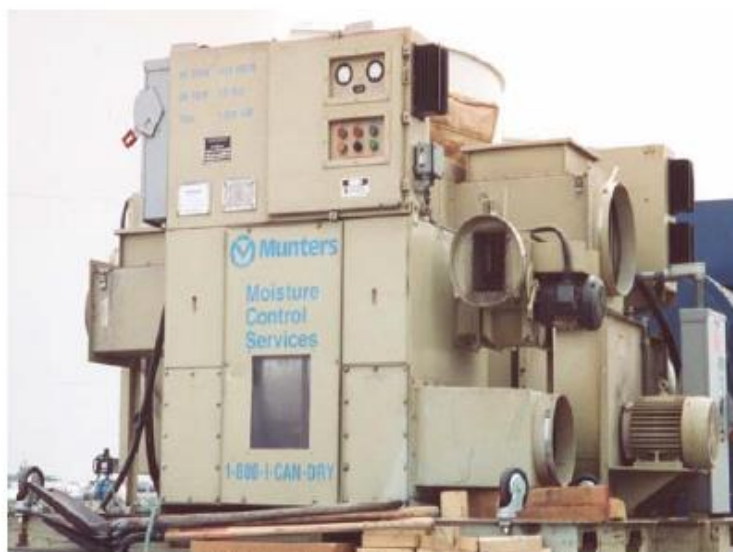
Слика 12: Уклањање влаге
