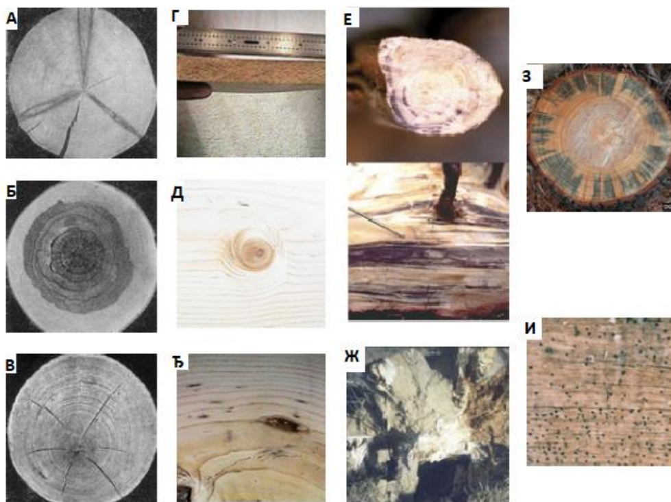
Слика 2.6. Грешке дрвета: А – грешке од остатака грана, Б – трулеж, В – распуклине, Г – бубрење, Д – флексибилност влакана, Ђ – смољне ћелије, Е – сржне мрље, Ж – пиравост, З – модрење, И – грешке од инсеката [16]
