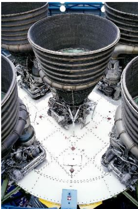
Слика 4.4 Ракетне млазнице од молибдена [26]
