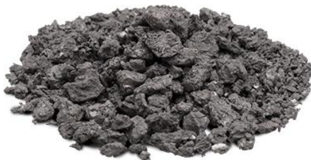
Слика 2.9 Сунђерасти титан добијен Кроловим поступком [41]
