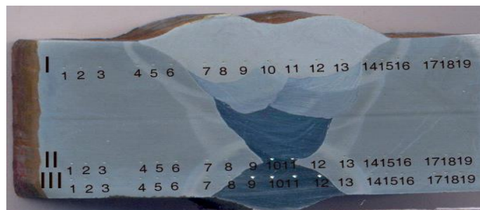
Слика 5.15 Металографски узорак - I за испитивање макроструктуре и мерење тврдоће сучеоно завареног споја [8]
