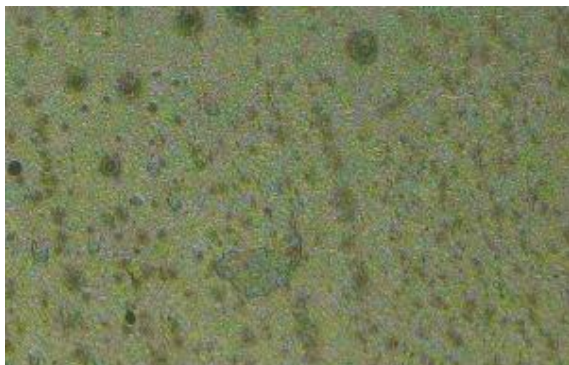
ОМ - мартензитно-бејнитна структура
