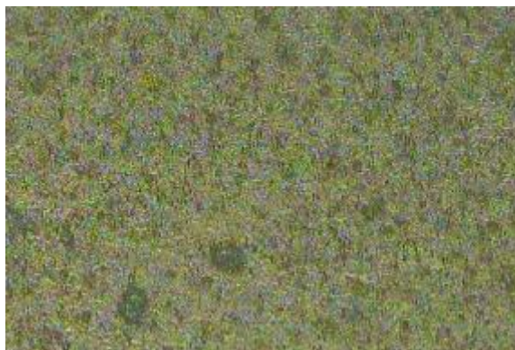
МШ - феритно-мартензитна структура и карбиди
