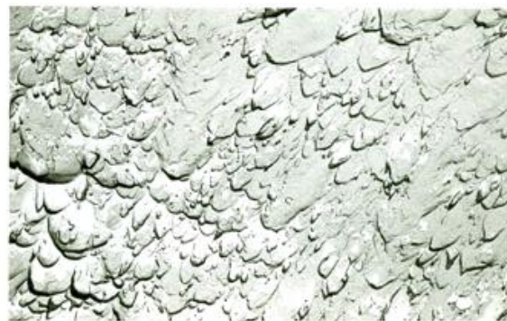
Слика 5.5 Крти и жилави лом под електронским микроскопом 1000x [8]
