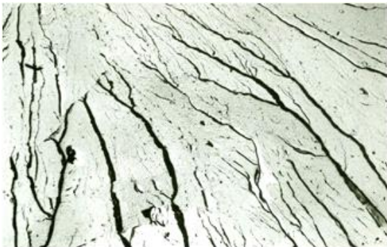
Слика 5.5 Крти и жилави лом под електронским микроскопом 1000x [8]
