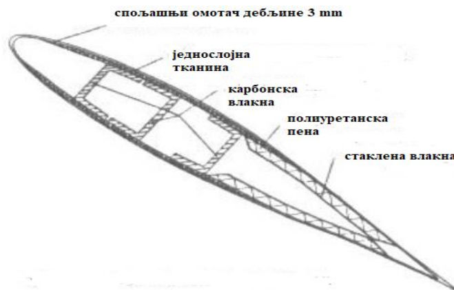
Слика 31. Попречни пресек лопатице ветротурбине [23]
