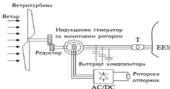
Слика 38. Ветроагрегат са индукционом машином са намотаним ротором као ветрогенератором [22]
